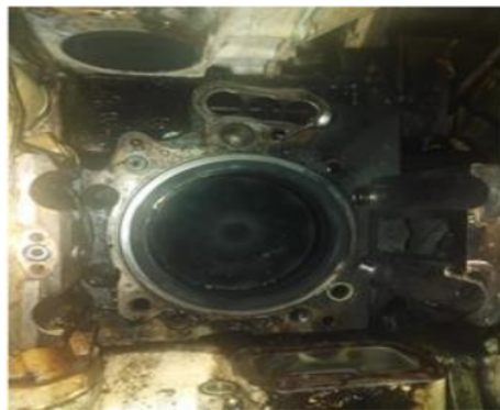
Ilustración 38: habitáculo de una culata extraída (motor principal)
