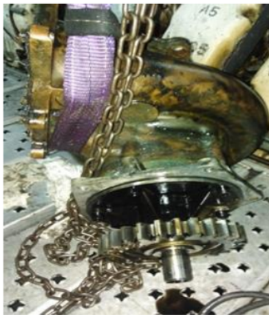
Ilustración 33: Extracción del turbo de alta presión (motor principal)
