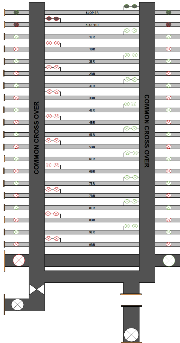
Ilustración 6. Colector principal, colector de popa y colector para muelle La Hondura. Fuente: Autor
