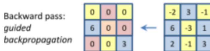
Figura 4.6: Ejemplo de propagación hacia atrás con derivada ReLu modificada
