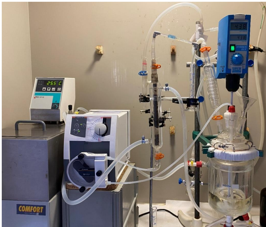
Figura 2.4. Equipo experimental para la adsorción del sistema continuo.
