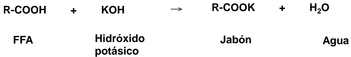
Figura 1.2. Reacción de saponificación (Knothe et al., 2005).
