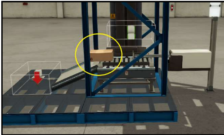
Figura 72.- Caja errónea siendo empujada
