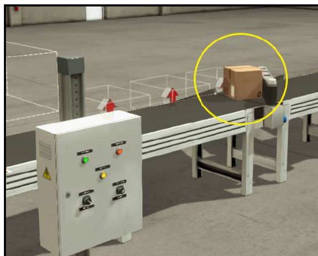
Desviador 1 activado. Pieza entrando en el almacén 1.
