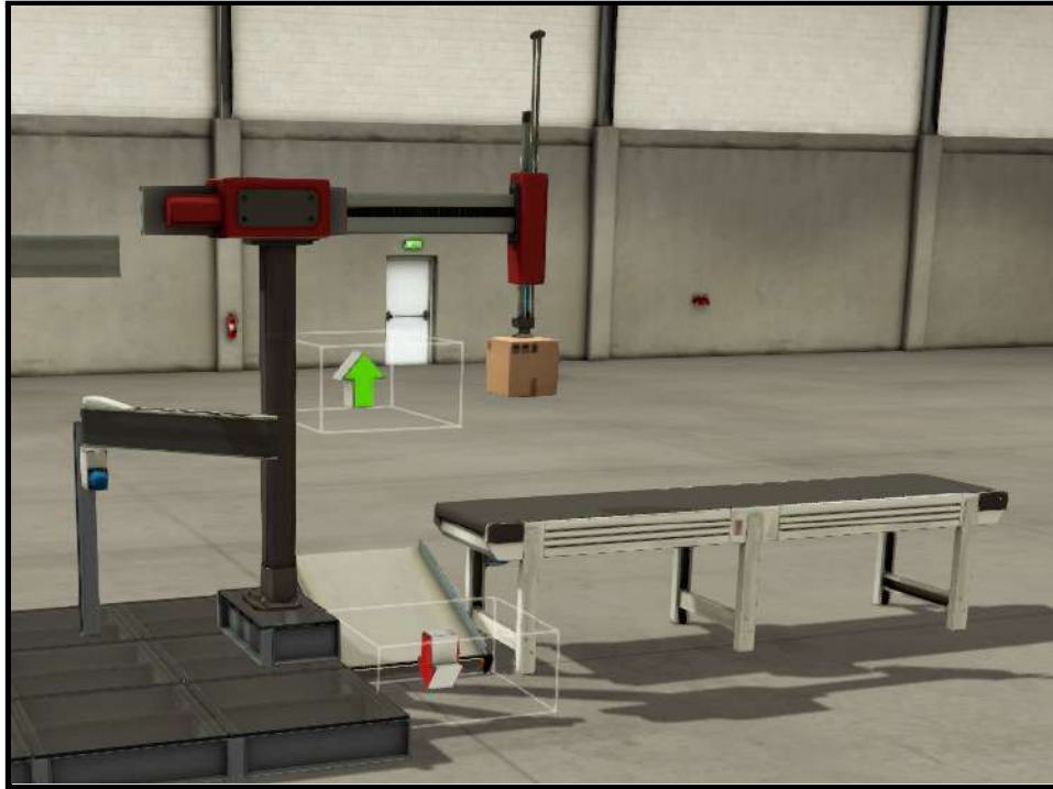
Figura 99.- Caja correcta. Mov brazo 2 horizontal
