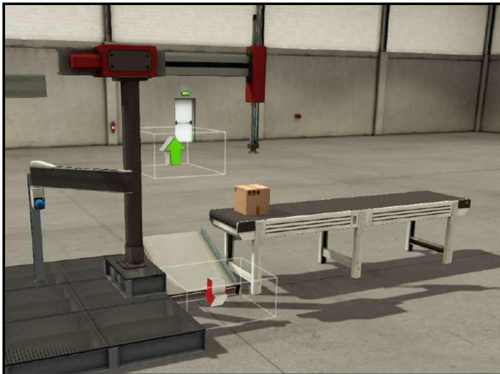
Figura 100.- Caja correcta. Mov brazo 2 vertical y ventosa OFF
