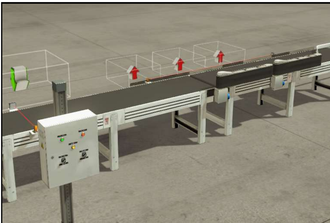
Figura 116.- Ningún desviador está activo. Salida caja almacén 3.
