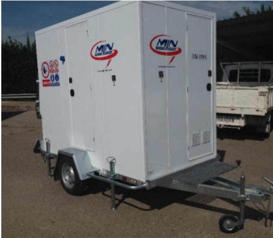
Fig. 24: Ejemplo de unidad móvil de descontaminación de amianto
