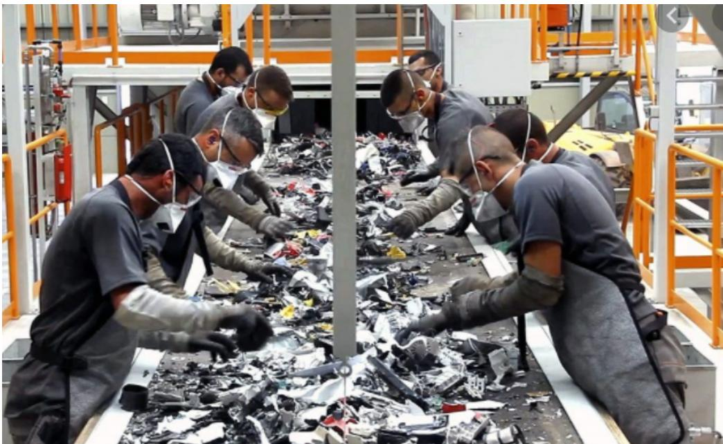
**Fig. 9:** El desmontaje se suele realizar mediante procesos manuales para la recuperación de componentes como carcasas, cables externos y baterías. Fuente: <https://www.ewaste.es/>
