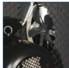
Refrigeración con ventilador eléctrico adicional (en unidades de 7,5 y 10 CV)
