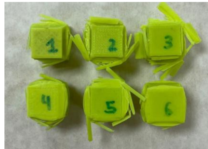
Figura 69. Probetas compresión PLA reciclado post-ensayo. Fuente: propia
