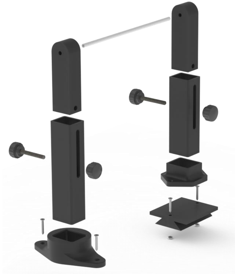
Figura 30. Vista explosionada del subconjunto 2. Fuente: propia
