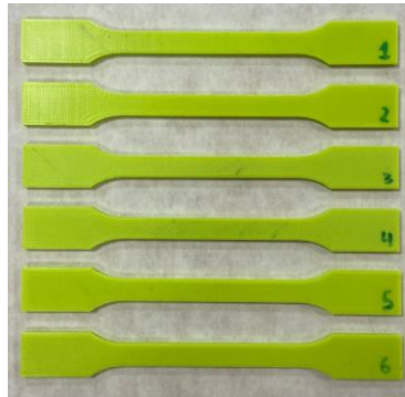
Figura 55. Probetas tracción PLA reciclado pre-ensayo. Fuente: propia
