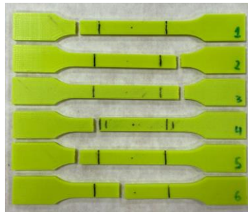
Figura 56. Probetas tracción PLA reciclado post-ensayo. Fuente: propia
