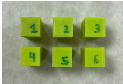
Figura 68. Probetas compresión PLA reciclado pre-ensayo. Fuente: propia
