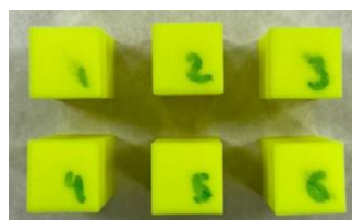
Figura 64. Probetas compresión PLA industrial pre-ensayo.
