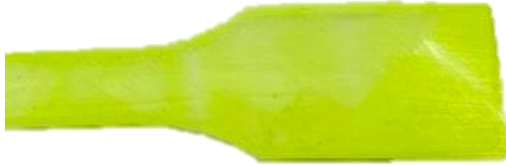
Figura 47. Impresión fallida por atasco del extrusor. Fuente: Propia
