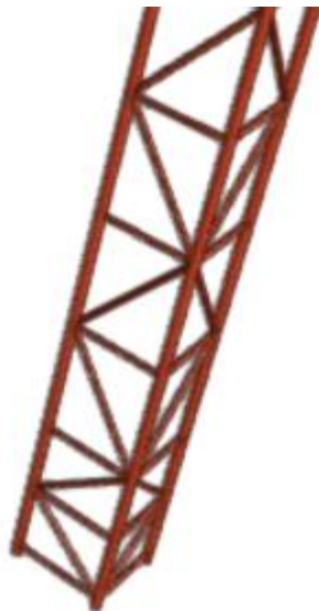
Ilustración 11: Detalle de la forma del Soporte del Pórtico frontal. Fuente: CYPE 3D
