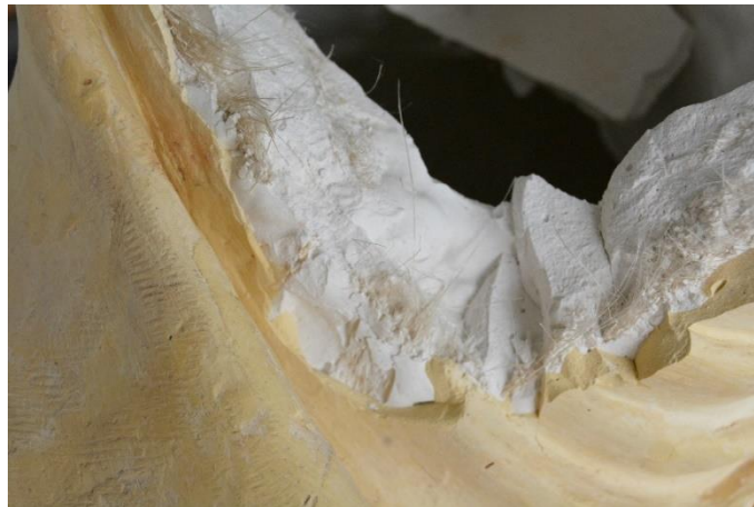
Ilustración 60. Diferenciación entre colada a color y coladas blancas con refuerzos.
