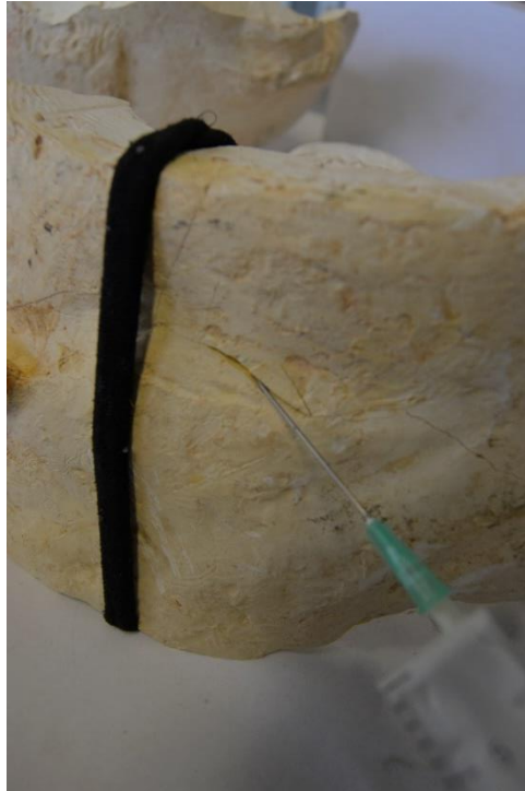
Ilustración 29. Inyección en parte de CM1.
