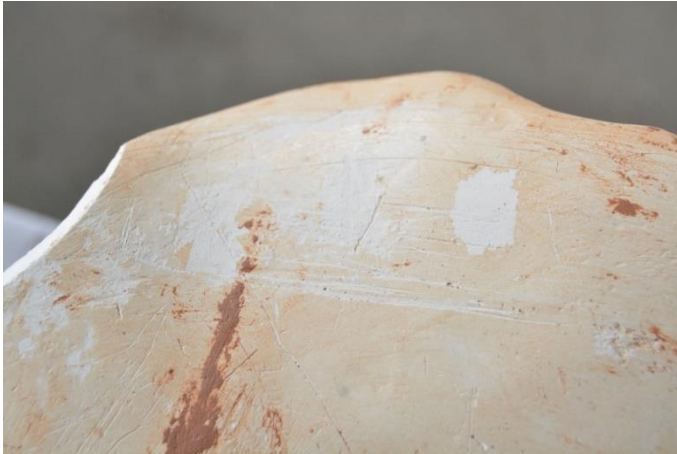
Ilustración 4. Resultado de la retirada de las 3 muestras sobre parte posterior de BE donde se comprueba la efectividad de la mezcla al 8%.
