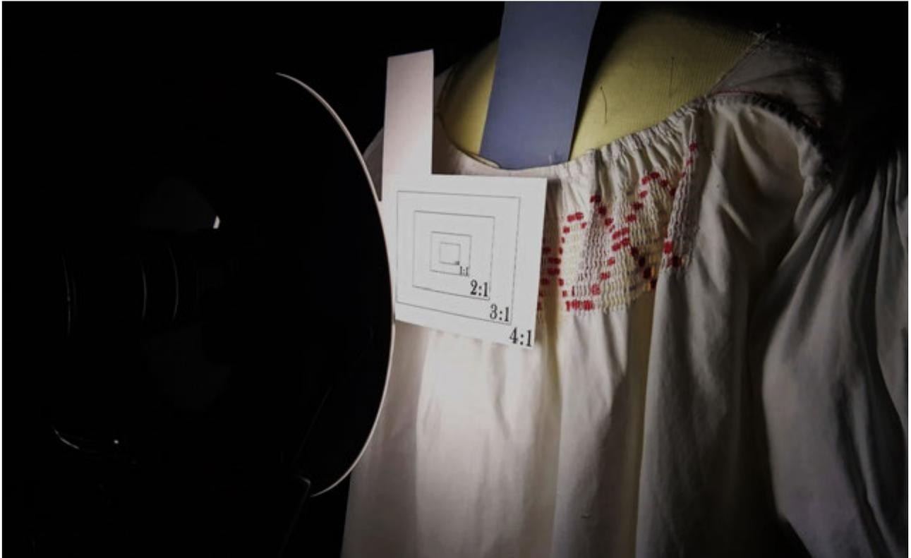
033: Colocación de la plantilla para determinar el nivel de ampliación que se está obteniendo
