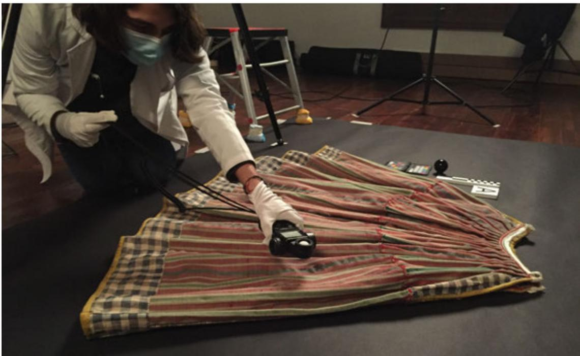
026: Comprobación con fotómetro de la intensidad de la luz sobre el lado derecho de la prenda
