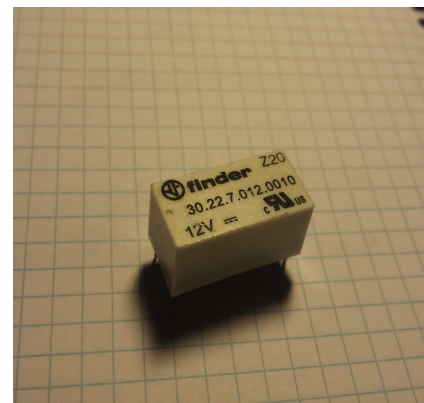
Figura 23. Relé Finder de 12 V y 2 A. Componente empleado en el trabajo.
