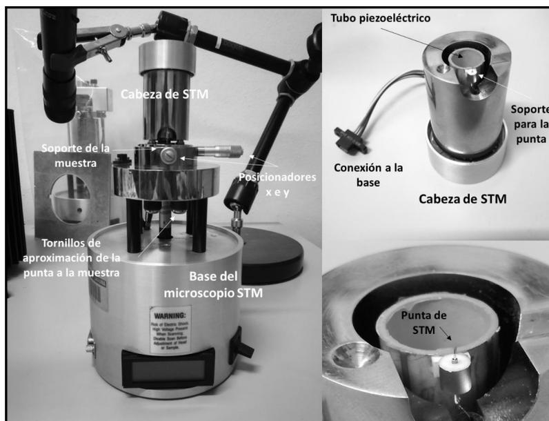
Figura 2.12. Equipamiento de medidas de STM. Izquierda: Base del equipo Nanoscope IIE. Derecha: scanner y detalle del soporte donde se introduce la punta de STM.
