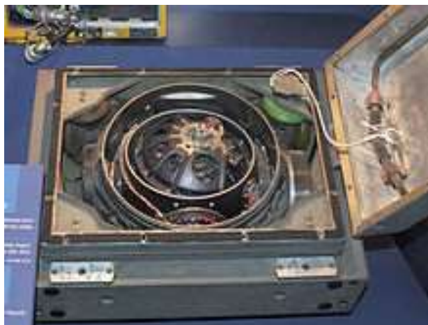
Ilustración 10. UMI (Unidad de medición inercia). Fuente: wikipedia.org
