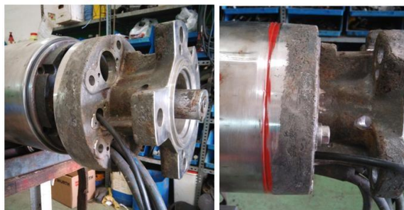
Ilustración 114: Montaje de la cabeza del motor y fijación de tornillería y silicona
