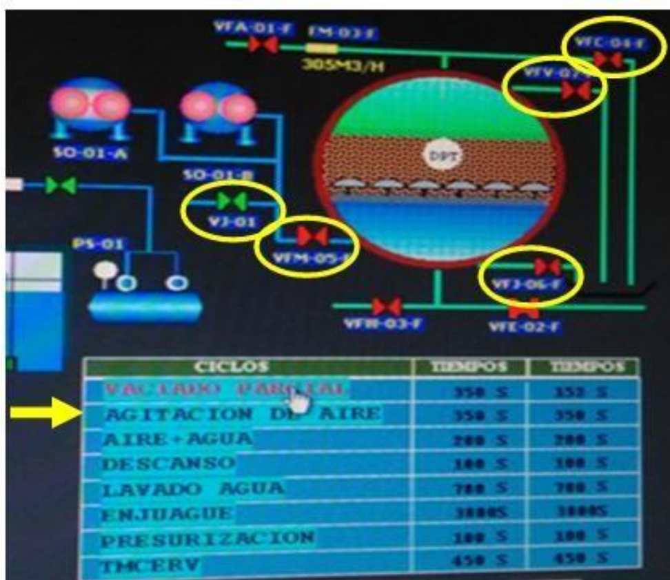
Ilustración 56: Pantalla de lavado de filtro. Paso 2
