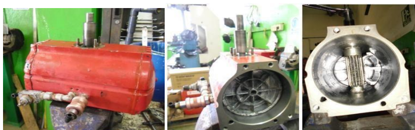
Ilustración 136: Desmante y comprobación de la cámara
