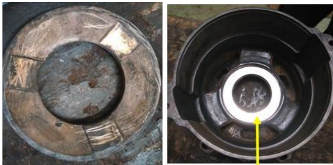
Ilustración 107: Pieza de bronce desgastada y arandela de ajuste
