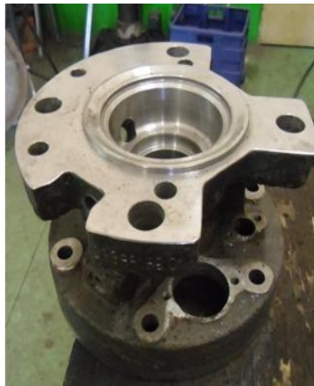
Ilustración 102: Limpieza de la nueva cabeza del motor
