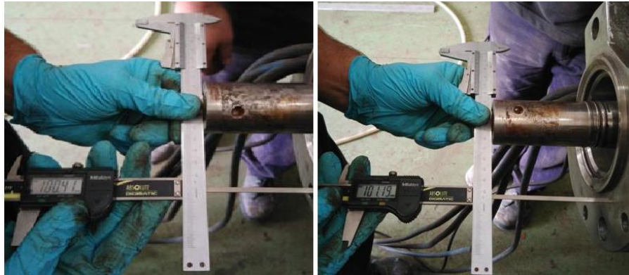
Ilustración 116: Primera medida 100,41 \approx 100,4 mm y la segunda medida 101,19 \approx 101,2 mm
