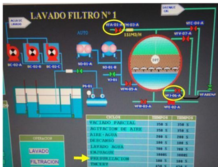
Ilustración 66: Pantalla de lavado de filtro. Paso 7
