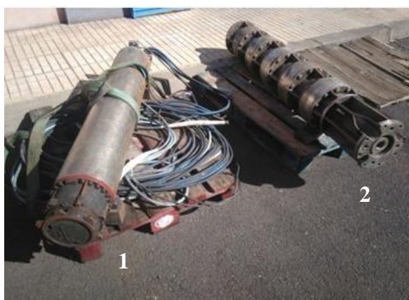
Ilustración 80: Grupo sumergible, compuesto por motor eléctrico (1) y bomba (2)
