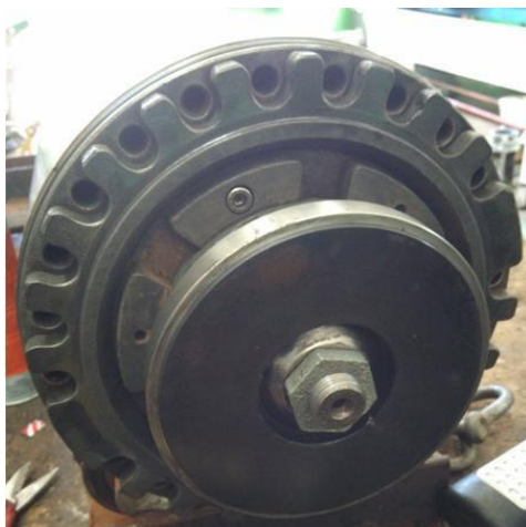
Ilustración 105: Colocación del disco soporte y ajuste con su tuerca
