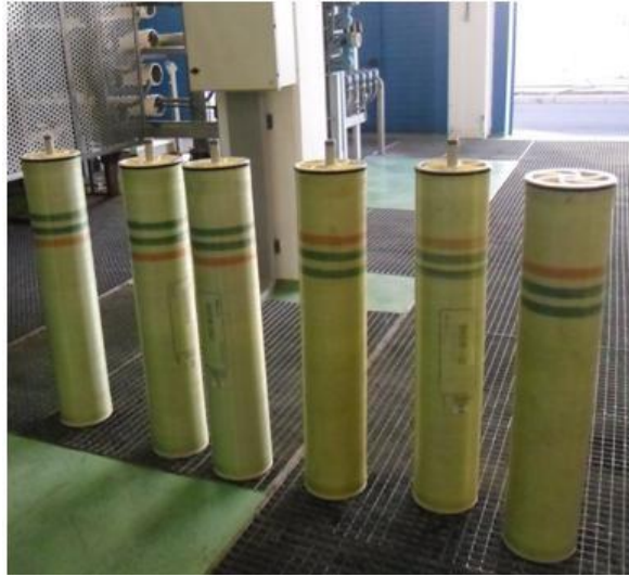
Ilustración 78: Membranas listas para ser introducidas en el tubo
