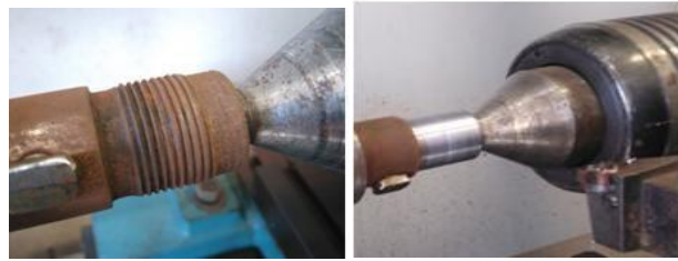
Ilustración 95: Rosca exterior desgastada (1) y realizando el plano (2)
