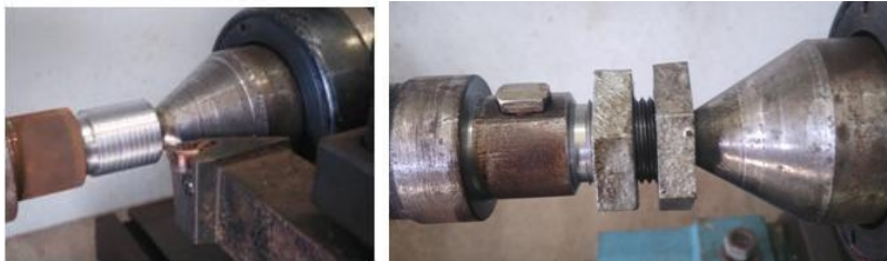
Ilustración 96: Realizando rosca exterior (1) y colocación de tuerca-contratuerca (2)
