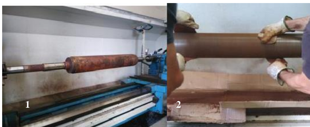
Ilustración 89: Rotor sin lijar (1) y proceso de lijado (2)
