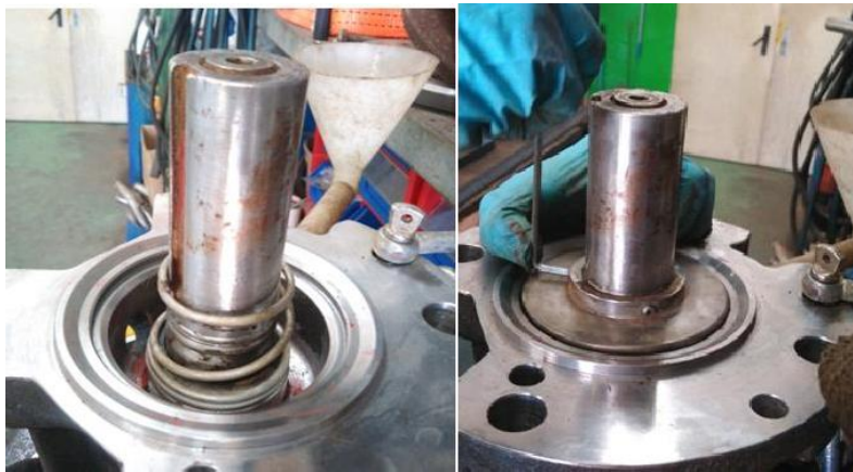
Ilustración 125: Colocación y fijación del sello mecánico
