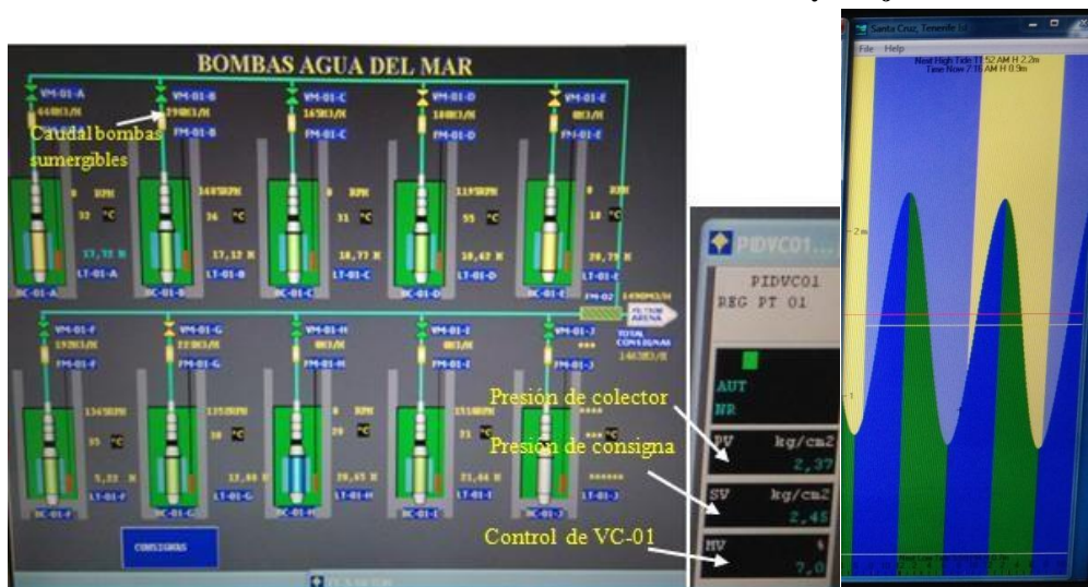
Ilustración 28. Pantalla de bombas de mar y oleaje
