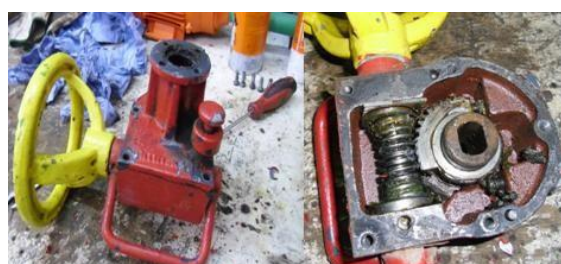
Ilustración 137: Desmontaje de la reductora
