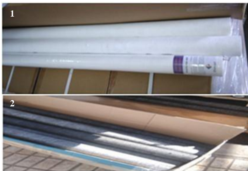
Ilustración 15. Filtros limpios (1) y sucios (2).
