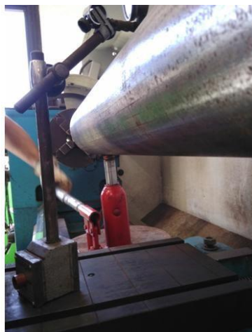
Ilustración 93: Alineamiento con el gato hidráulico
