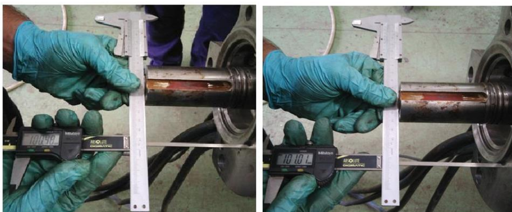
Ilustración 117: Primera medida 100,48 mm y la segunda medida 101,01 mm
