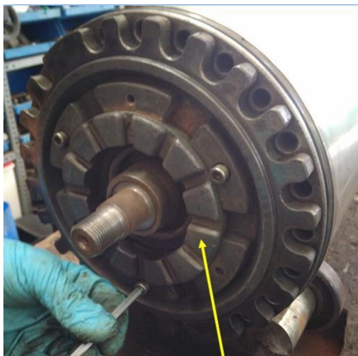
Ilustración 104: Fijación de tornillos del cojinete contra-axial
