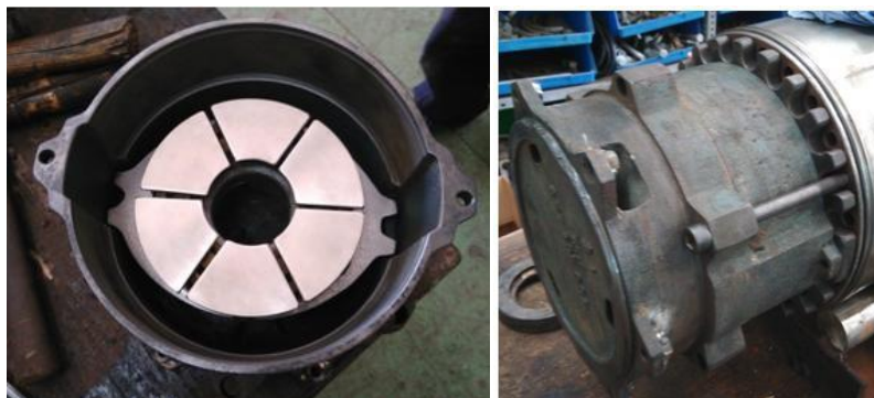
Ilustración 113: Piezas de regulación alojadas en el porta-cojinete y este atornillado al motor
