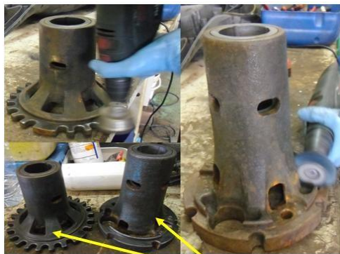
Ilustración 97: Limpieza de portacojinete trasero (1) y delantero (2)
