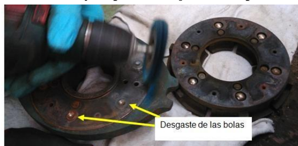
Ilustración 109: Desmonte y limpieza del cojinete axial producido por las bolas
