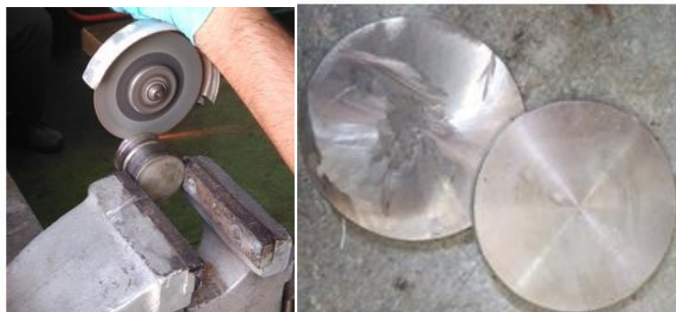
Ilustración 122: Proceso de corte con la radial y arandelas macizas ya cortadas
