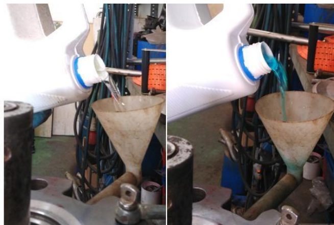
Ilustración 124: Llenado del motor con agua y anticongelante
