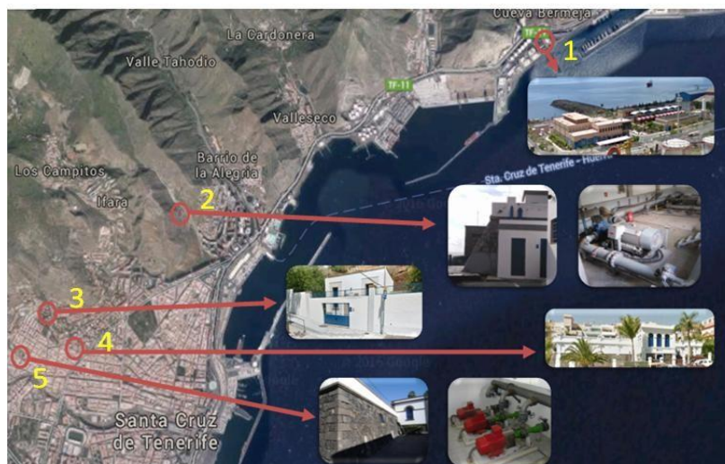
Ilustración 10. Distribución de depósito y estaciones de bombeo
