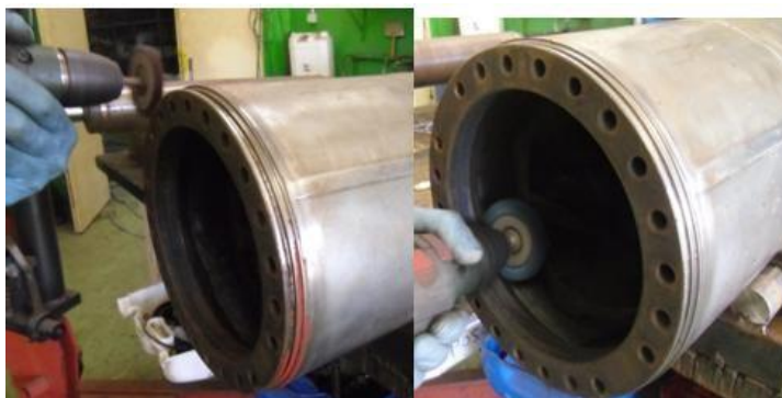
Ilustración 98: Limpieza del cuerpo del estator y sus juntas
