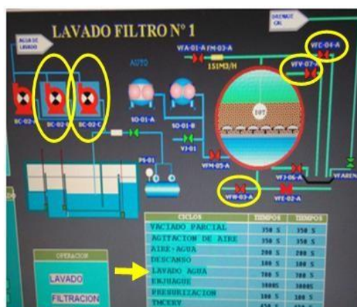
Ilustración 62: Pantalla de lavado de filtro. Paso 5
