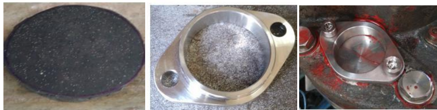
Ilustración 123: Tapón de goma y arandela gafa ajustada en el orificio
