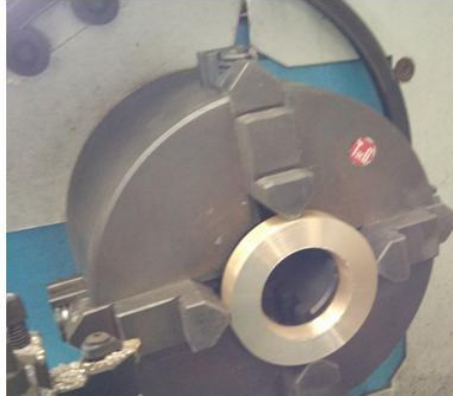
Ilustración 112: Haciendo rectificando en el torno a la nueva pieza de bronce
