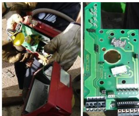
Ilustración 135: Desconexión y comprobación de la tarjeta electrónica
