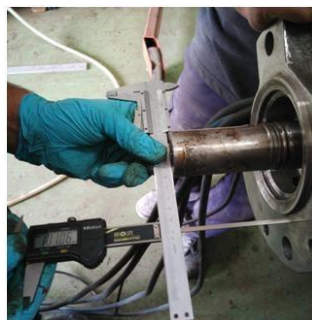
Ilustración 115: Primera medida 101,06 \approx 101,1 mm
