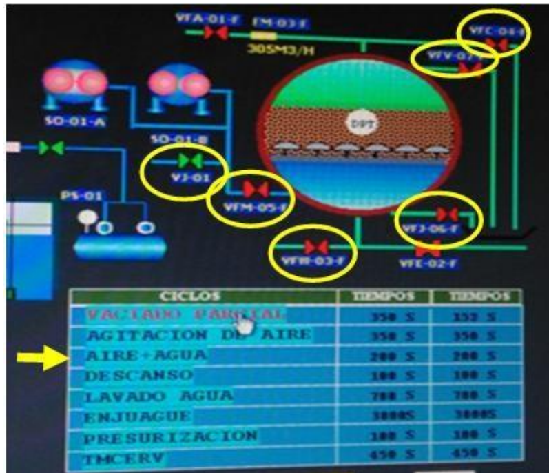
Ilustración 58: Pantalla de lavado de filtro. Paso 3
