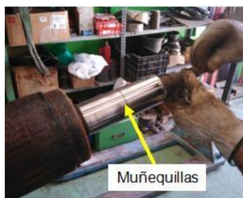
Ilustración 84: Lijando de la rosca exterior
