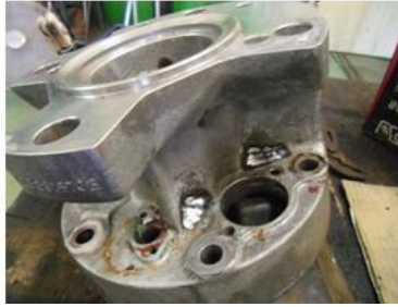
Ilustración 101: Cabeza del motor que necesita soldadura
