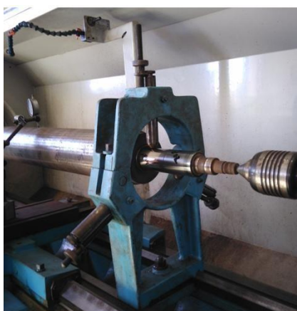
Ilustración 94: Alineamiento con la luneta
