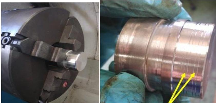
Ilustración 121: Tocho de acero inoxidable y ranuras hechas en el torno
