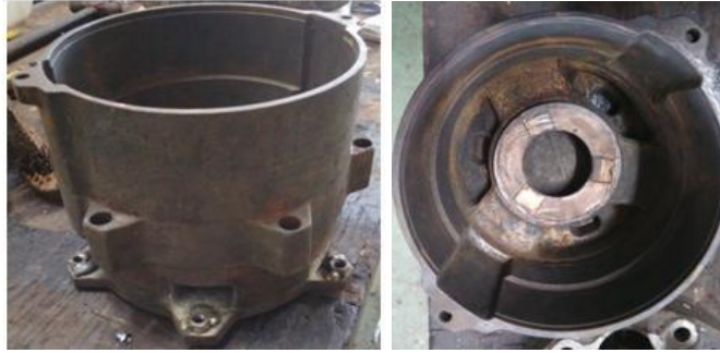
Ilustración 106: Porta-cojinete e interior del porta-cojinete
