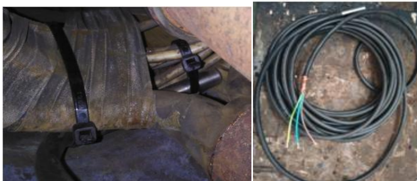
Ilustración 103: Sonda PT100 acoplada en el interior del motor
