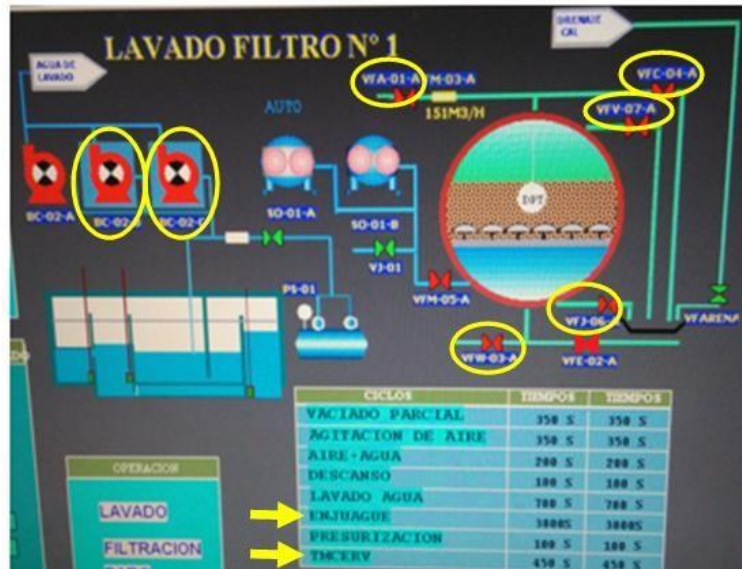
Ilustración 64: Pantalla de lavado de filtro. Paso 6
