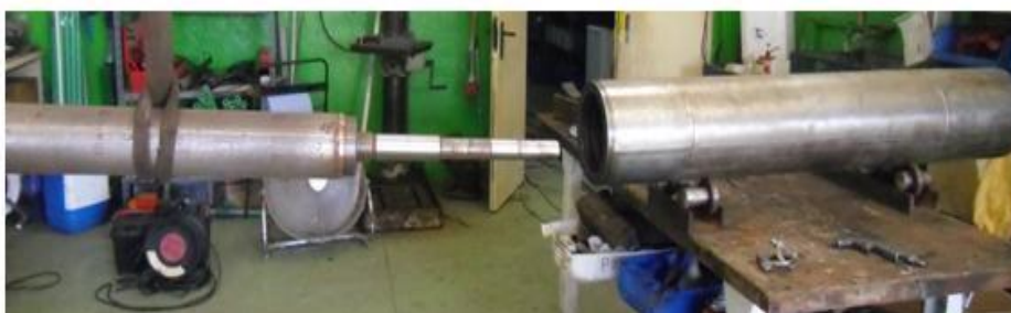
Ilustración 99: Se introduce el rotor en el interior del estator
