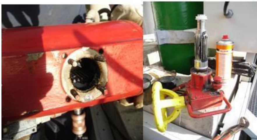
Ilustración 134: Desmontando el vástago con la reductora
