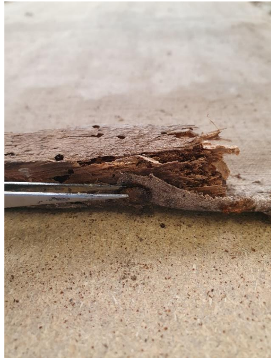
Ilustración 65.- Extracción de restos de insectos durante la separación de los clavos del bastidor y del marco, concretamente de la zona inferior de la obra. Ilustración 66.- Extracción de clavos oxidados del bastidor, se aprecia el estado grave de conservación de la madera.
