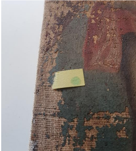
Ilustración 39 y 40.- Medida de pH con tira de medidas en la parte inferior izquierda del lienzo. El proceso consiste en añadir una gota de agua sobre el soporte, dejar que se asiente y mojar la tira, de esta manera, reacciona y nos determina con colores el nivel del pH.
