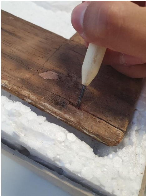
Ilustración 102.- Detalle de extracción del nudo. Incisión en la madera 1. Punzón.
