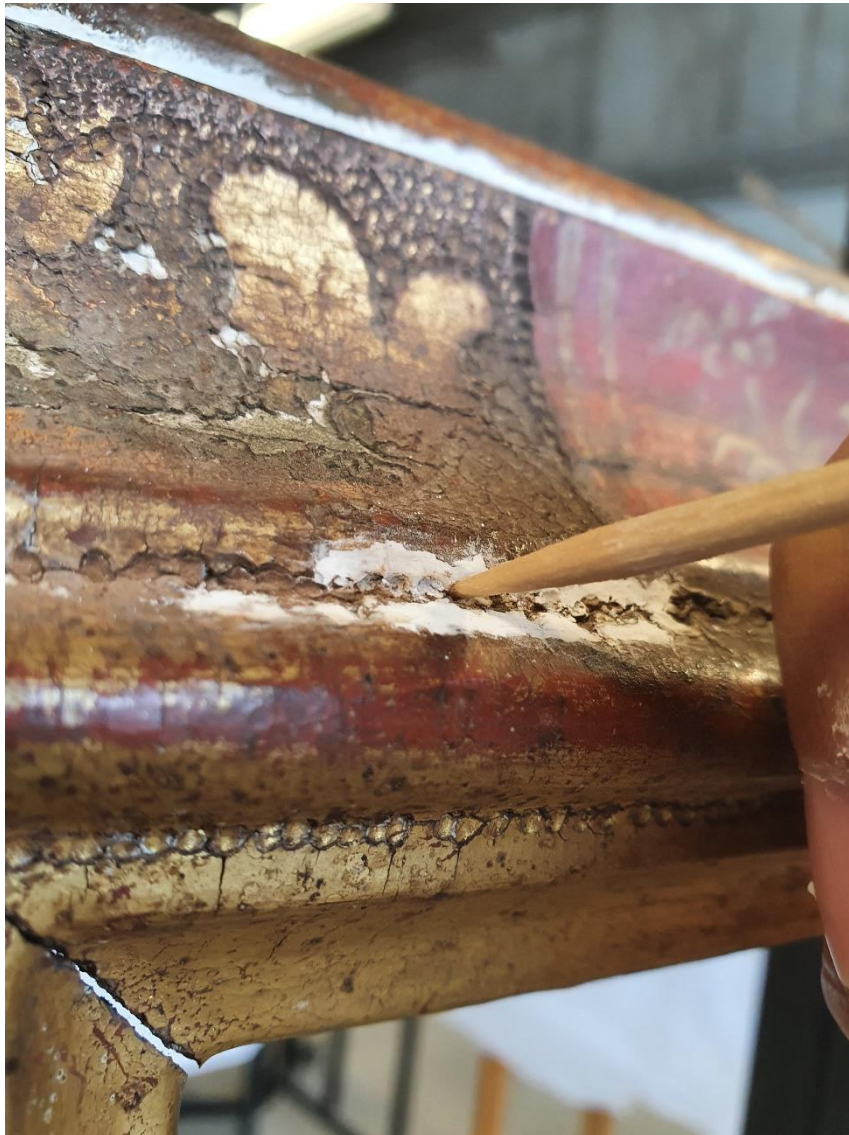
Ilustración 124.- Imitación de la textura de los repicados en el estucado. Para ello se ha utilizado un palo de madera de hisopo, ya que la punta presenta el mismo grosor del repicado original.
