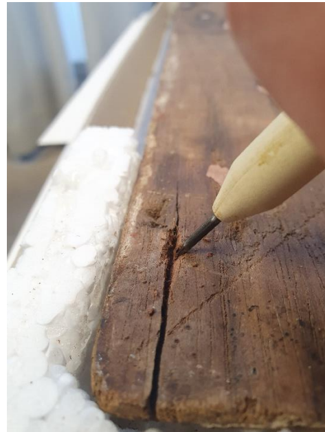
Ilustración 103.- Detalle de extracción del nudo, incisión en la madera 2. Punzón.
