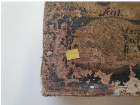
Ilustración 39 y 40.- Medida de pH con tira de medidas en la parte inferior izquierda del lienzo. El proceso consiste en añadir una gota de agua sobre el soporte, dejar que se asiente y mojar la tira, de esta manera, reacciona y nos determina con colores el nivel del pH.
