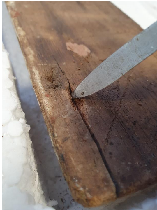
Ilustración 104.- Detalle de incisión con escarpelo para la eliminación total del nudo.
