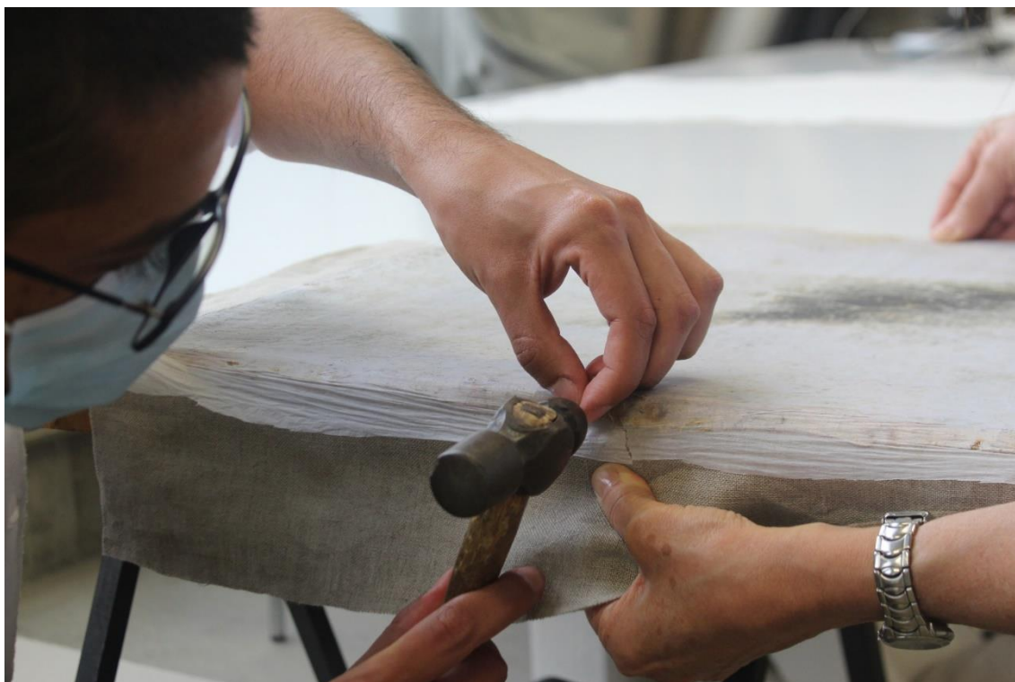
Ilustración 158.- Claveteado puntual de los bordes para la colocación de las grapas.
