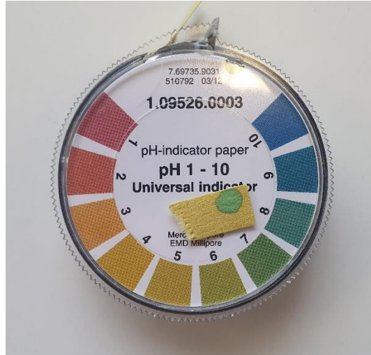
Ilustración 39 y 40.- Medida de pH con tira de medidas en la parte inferior izquierda del lienzo. El proceso consiste en añadir una gota de agua sobre el soporte, dejar que se asiente y mojar la tira, de esta manera, reacciona y nos determina con colores el nivel del pH.
