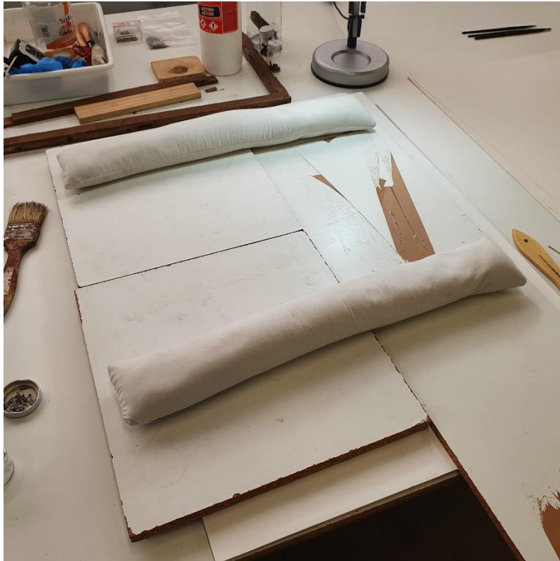
Ilustración 141.- Proceso de corrección de la deformidad de la tela con humedad. Papel secante y peso de manera uniforme.
