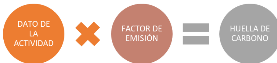
Figura 11 Fórmula para obtener una cantidad determinada de dióxido de carbono equivalente. Fuente: (MITECO, 2016).
