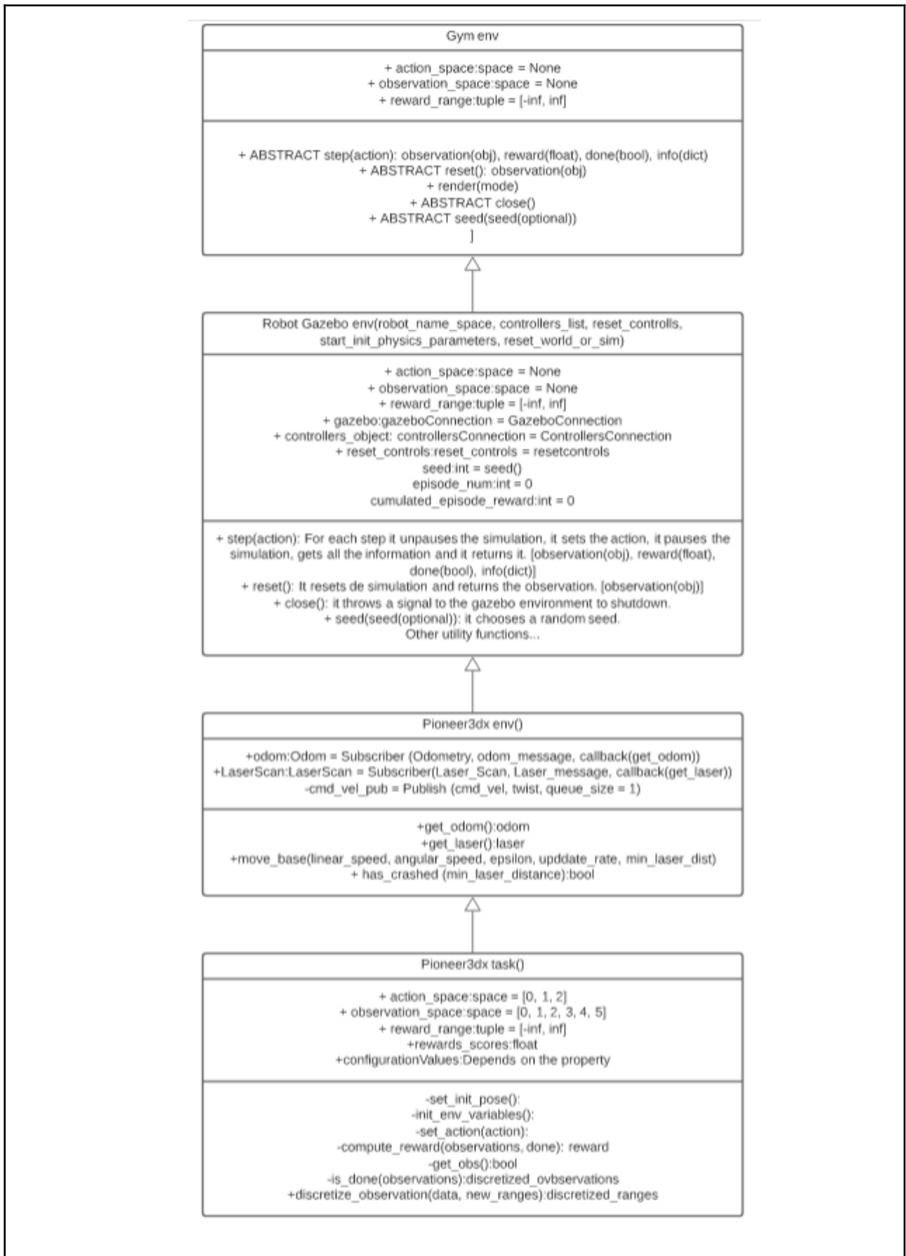
Figura 6.1: Diagrama UML de las clases principales involucradas para representar el robot.
