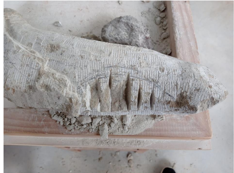
Figuras 69 y 70. En estas dos imágenes pude apreciarse un ejemplo de desbaste con martillo neumático y martillo y cincel convencionales.
