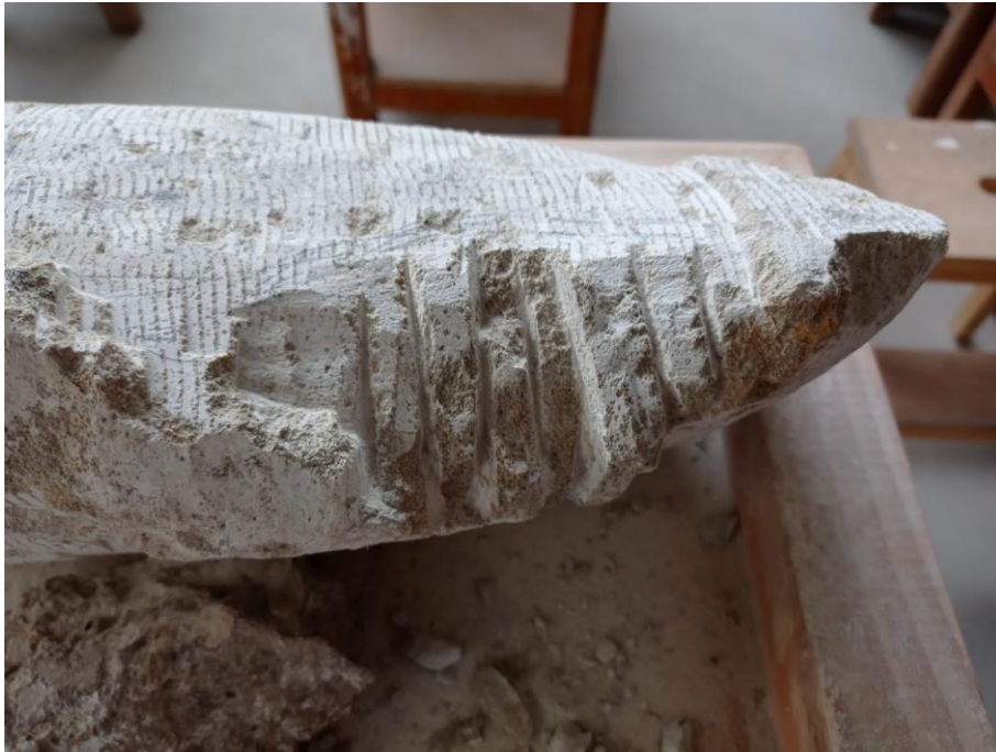
Figuras 69 y 70. En estas dos imágenes pude apreciarse un ejemplo de desbaste con martillo neumático y martillo y cincel convencionales.
