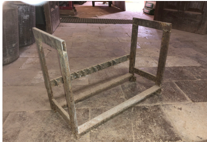
Estructura para el fraguado.
