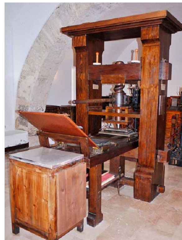
Réplica de la prensa de Gutenberg y de los tipos móviles. Recuperado de https://www.laimprentacg.com/quien-invento-la-imprenta/
