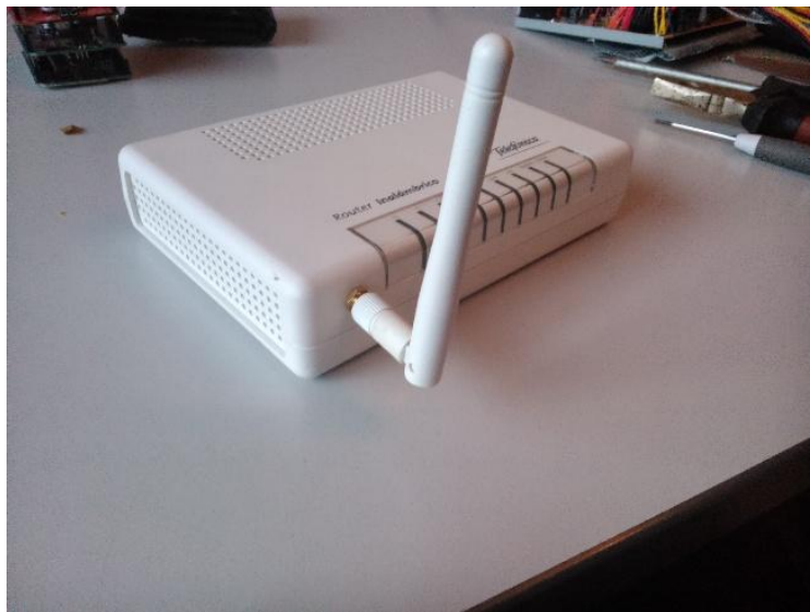
Figura 3.11. Antena wifi montada en la parte frontal del router.
