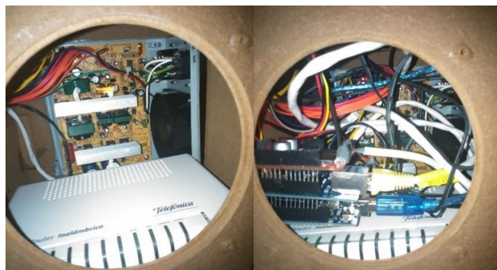
Figura 3.14. Router wifi y fuente de alimentación introducidos en la caja (izquierda) y toda la electrónica centralizada (derecha).
