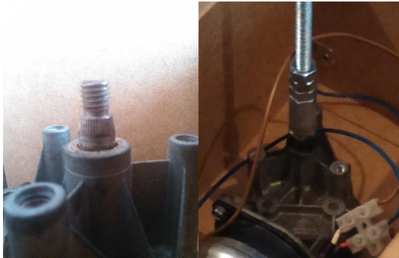
Figura 4.8. Eje roscado del motor (izquierda) y varilla roscada acoplada al eje del motor por medio de una tuerca métrica hexagonal seguida de tres tuercas (derecha).
