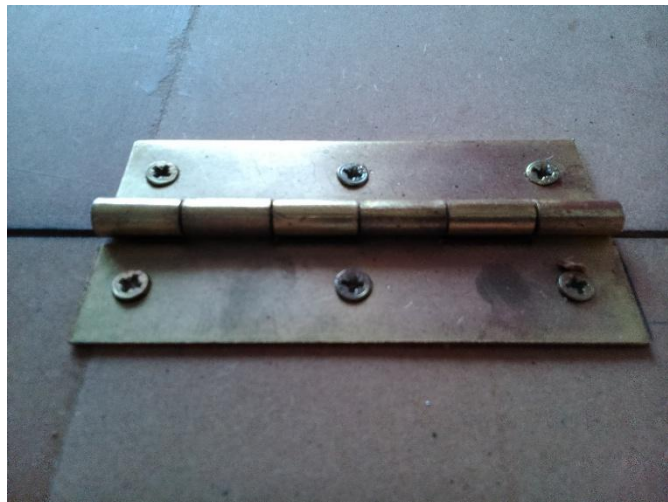
Figura 4.2. Una de las bisagras que unen las dos mitades de la base principal.
