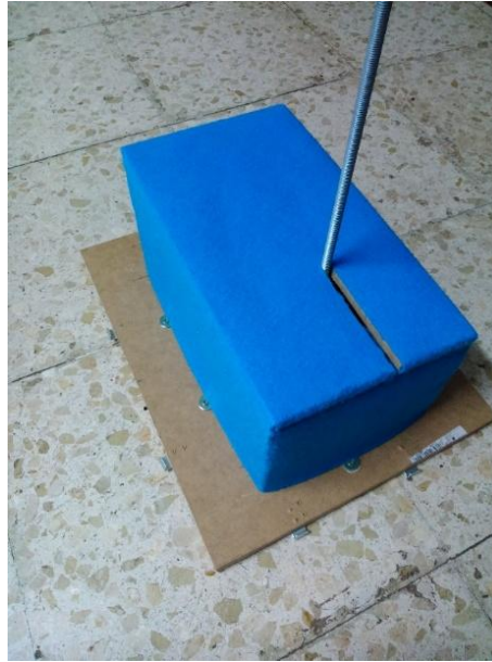
Figura 4.17. Tapa de la caja del motor forrada y colocada.
