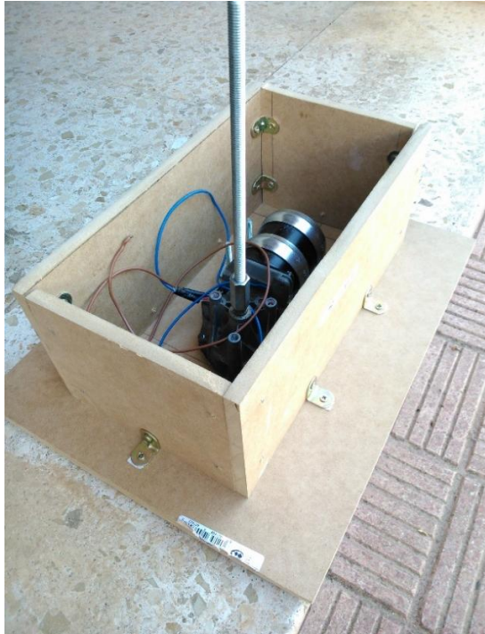
Figura 4.5. Motor anclado a su base y envuelto en una caja de madera.
