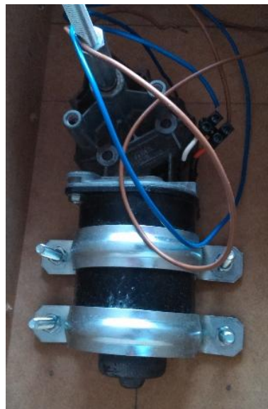
Figura 3.3 Motor DC con sujeción utilizado en el prototipo.
