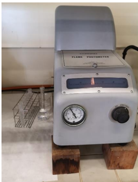
Figura 39: Determinación de la concentración de K^+ o Na^+ en el fotómetro de llama.
