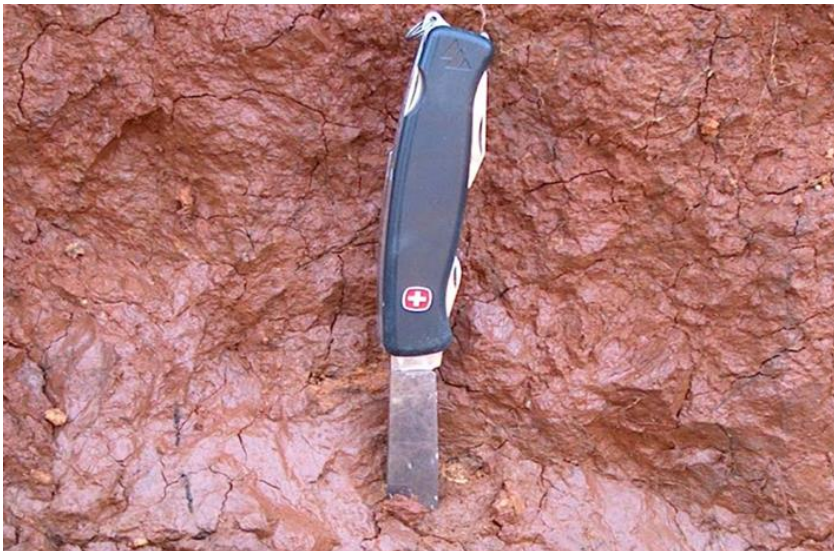
Figura 5.11. Suelo ándico, arcilloso (haloisita y oxihidróxidos de hierro), N4. Zona Karting, Tenerife
