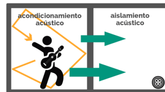
Fig. 35: Acondicionamiento y aislamiento acústico
