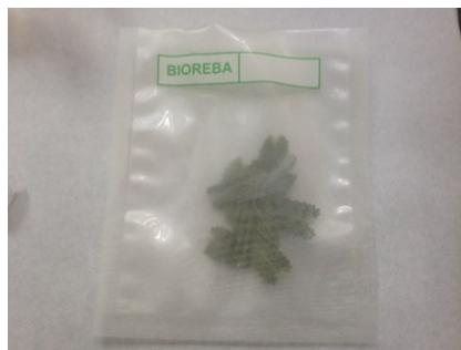
Figura 6.16.- Extraction bags “Universal” 12x15cm de la casa comercial BIOREBA, utilizadas para la homogeneización de las muestras vegetales
