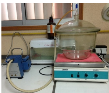
Figura 4.3.- a) Desecador conectado a una bomba de vacío, y agitador (Labnet. SHAKER40) utilizada en nuestro laboratorio durante la fase de esterilización de las semillas de Nepeta teydea .
