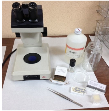
Figura 3.12.- Lupa Leica ZOOM. 2000™ (Model No. Z30V. 240V) e instrumental de laboratorio utilizado para la obtención de las epidermis foliares.
