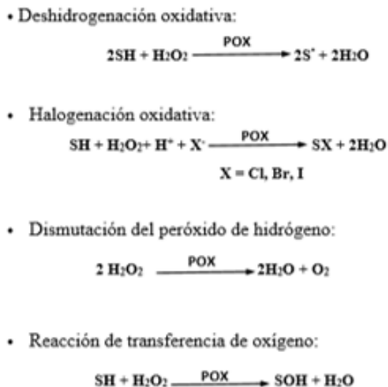
Figura 6.6.- Diferentes tipos de reacciones llevadas a cabo por las peroxididasas (Colonna et al., 1999).
