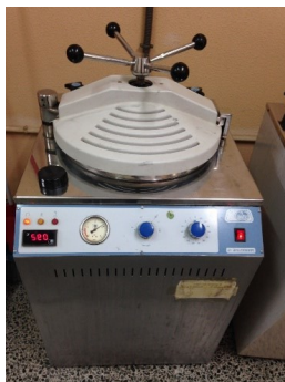
Figura 4.6.- Autoclave vertical Selecta Autotester (Mod. 437-G) utilizado en nuestro laboratorio para la esterilización del instrumental de laboratorio, agua destilada, y medios de cultivo.
