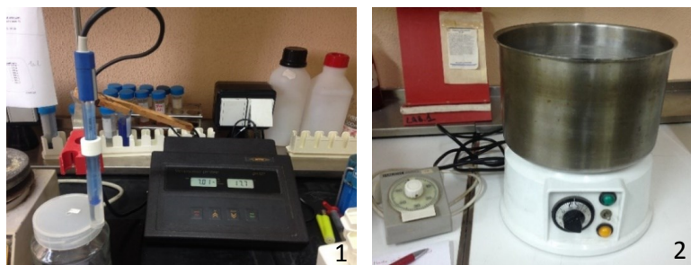
Figura 6.30.- 1) pH-metro empleado en los ensayos bioquímicos (WTW. Serie 537); 2) Baño termostático (Büchi. Switzerland. Volt: 220. Vatios: 1200)
