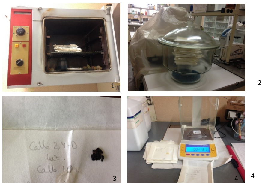
Figura 4.30.- 1) Estufa HERAEUS (HANAU.220V. 5,2A) en la que se deshidrataron los callos de Nepeta teydea de los diferentes ensayos de inducción de callo; 2) Desecador utilizado para evitar la hidratación de los callos desecados; 3) Aspecto de un callo de Nepeta teydea desecado; 4) Calculando el peso seco de los callos de Nepeta teydea , obtenidos en los diferentes ensayos.
