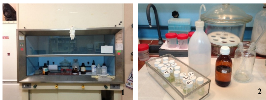
Figura 3.4.- 1) Cámara de extracción de aire que se utilizó durante el procedimiento histológico; 2) Procedimiento de fijación con F.A.A de las muestras de hojas, tallos y raíces de Nepeta teydea .
