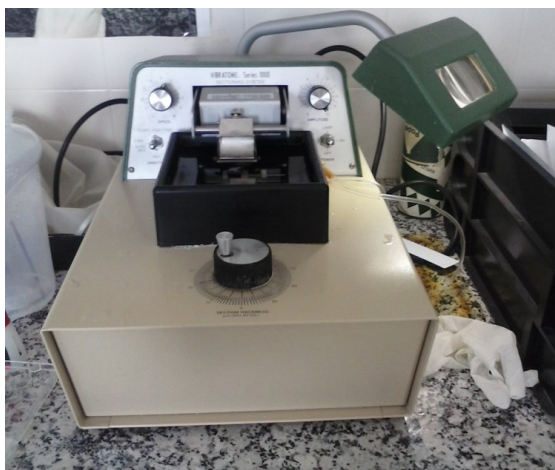
Figura 6.38.- Vibratomo (Lancer Vibratome Series 1000 Sectioning System) utilizado para la obtención de las secciones de hojas y tallos de Nepeta teydea para el estudio histoquímico de las peroxididasas.
