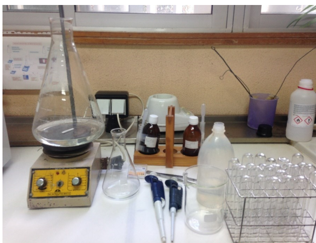
Figura 4.13.- Rotor magnético (P SELECTA AGIMATIC. Watt:400. Volt: 220) y restos de material de laboratorio, utilizado durante la preparación de los diferentes medios de cultivos empleados en nuestros ensayos.
