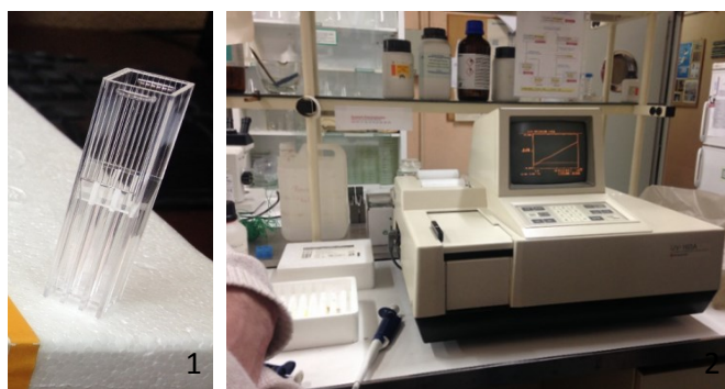
Figura 6.21.- 1) Cubetas semi-micro de polipropileno (VWR Cuvettes) utilizadas para hacer las mediciones espectrofotométricas; 2) Espectrofotometro UV-Vis. Shimadzu UV-160 A, empleado en los ensayos.
