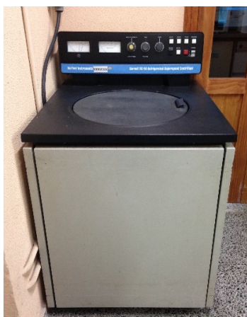
Figura 6.17.- Centrifuga Superspeed Sorvall RC-5B, utilizada para la centrifugación de los homogeneizados de las muestras vegetales.
