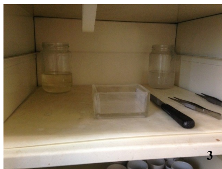
Figura 3.5.- Inclusión de las muestras de Nepeta teydea en paraplast: 1) Proceso de deshidratación; 2) Paraplast empleado para llevar a cabo este procedimiento, paraplast plus; 3) Fundición en una estufa a 60°C del paraplast.
