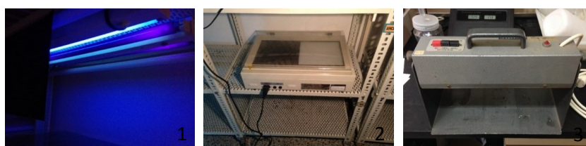
Figura 6.9.- Fuentes de luz ultravioleta de los ensayos utilizados: 1) Lámpara de luz blanca acoplada a una lámpara de luz UV (Philips TL-D 18W BLB 1SL); 2) Transiluminador White/UV.TLW-20; 3) Transiluminador UVATON.
