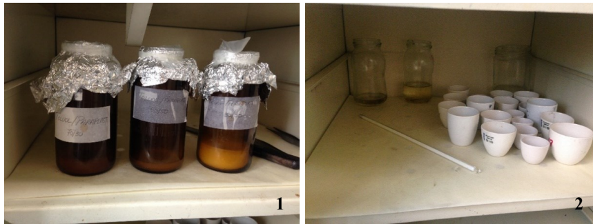
Figura 3.6.- Inclusión de las muestras vegetales de Nepeta teydea en paraplast: 1) Mezclas de tolueno/paraplast 70/30, 50/50 y 30/70; 2) Recipientes con las muestras vegetales sumergidas en paraplast puro
