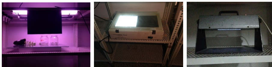
Figura 6.12.- Cámara de incubación con el sistema de inducción de estrés lumínico montado. Tratamiento lumínico de las muestras vegetales de Nepeta teydea en condiciones control (lámpara de luz blanca encendida).
