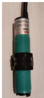
Figura 32. Sensor industrial IR 100 cm
