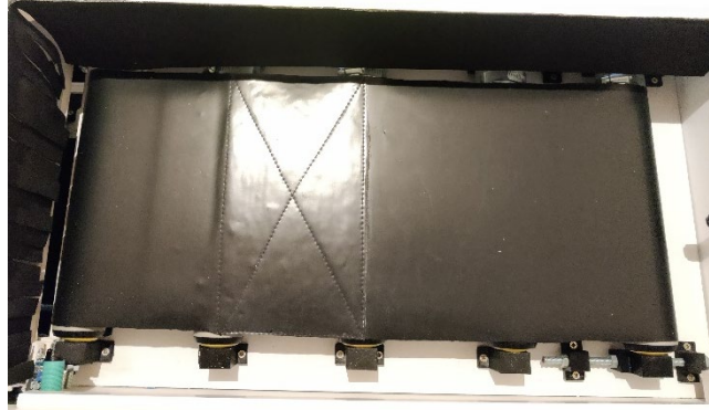
Figura 15. Cinta transportadora implementada
