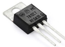
Figura 52. Regulador de tensión LM7812 [27]
