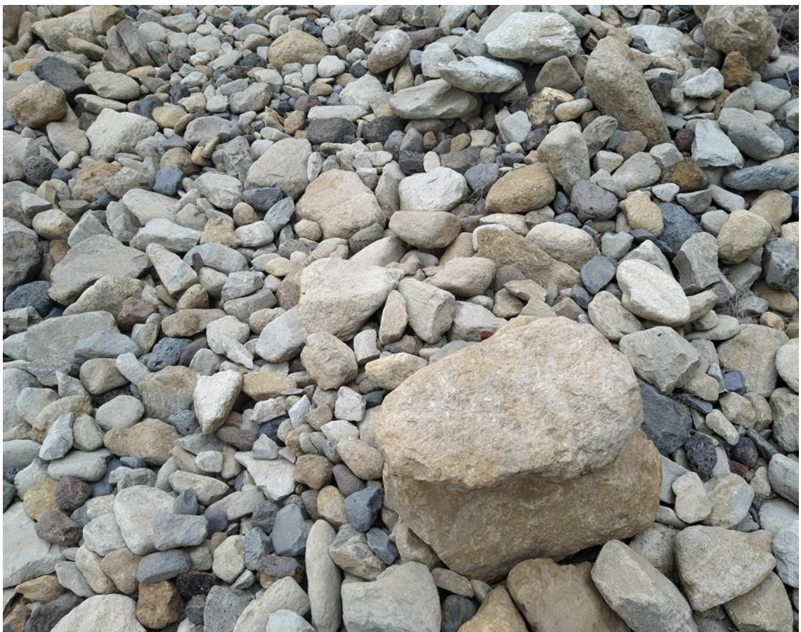
Fig.20. Diferencias de coloración entre las fonolitas, traquitas y el basalto.
