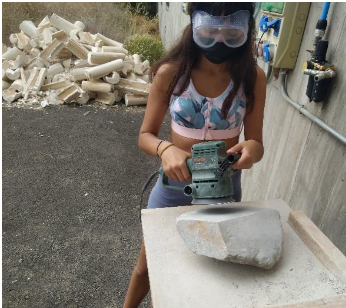
Fig. 47. Disco de lijado por velcro
