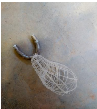
Fig. 50. Percutor de hierro galvanizado y nylon
