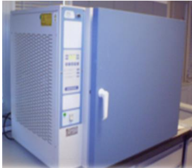
Figura 7: Estufa para la desecación de las muestras.
