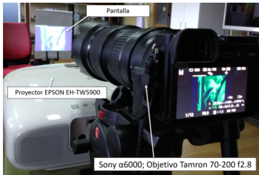
Figura 5.14 Montaje para la evaluación de la técnica sobre proyector EPSON EH-TW5900. Se hace uso de una cámara Sony \alpha 6000 con un objetivo Tamron 70-200 f2.8 para la adquisición de imágenes
