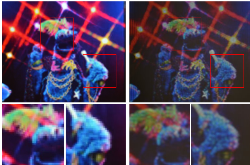
Figura 5.17 Comparación sobre proyector del pre-compensado multimodal para r'/r = (\sqrt{5}, 2\sqrt{2}, 3) . Se muestra de izquierda a derecha imagen de referencia y resultado, ambas representadas usando el mismo sistema.
