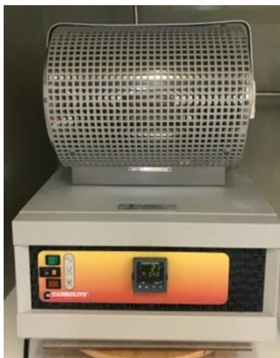
Figura 10: Horno *Carbolite 3216* empleado para el tratamiento térmico.
