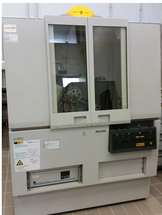
(a) Difractómetro de XRD modelo *Philips Panalytical X'Pert Pro*.
