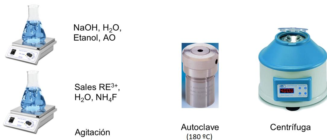
Figura 3: Esquema de los componentes empleados durante la síntesis de NCs mediante el método solvotermal.
