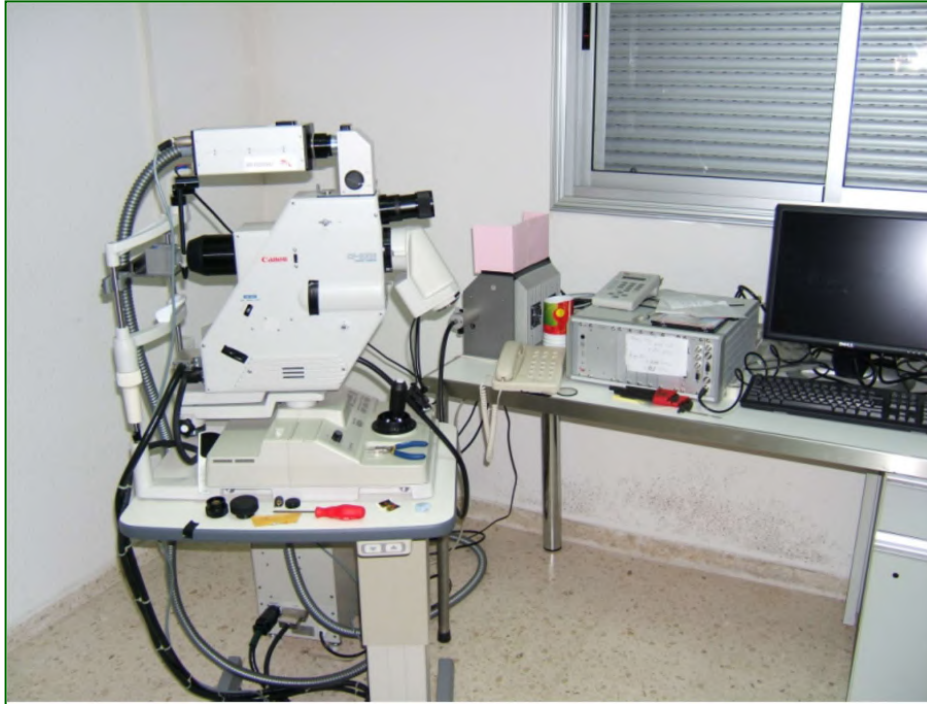
Figura 9.- Equipo para espectrofotometría de fondo de González de la Rosa (2006). Una cámara de video refrigerada de alta sensibilidad, se acoplaba a un retinógrafo Canon. La luz monocromática de iluminación le llegaba por una fibra óptica desde un monocromador comandado automáticamente mediante un equipo “Image System”.
