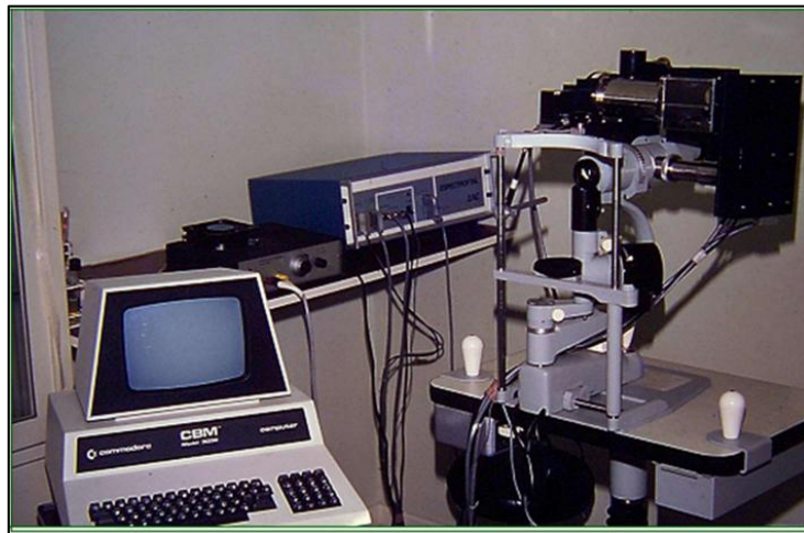
Figura 6.- Espectroftal, diseñado por nuestro grupo en la Universidad de La Laguna y el Instituto de Astrofísica de Canarias en 1980.
