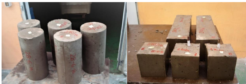
Figura 3.9.- Probetas de hormigón cilíndricas (izquierda), cúbicas y prismáticas (derecha).
