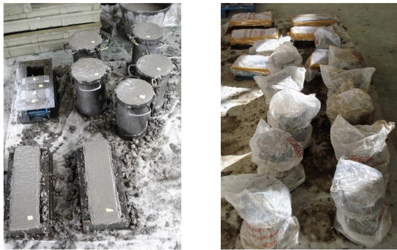
Figura 3.8.- Probetas de hormigón contenidas en su molde (izquierda) y cubiertas con plásticos (derecha).
