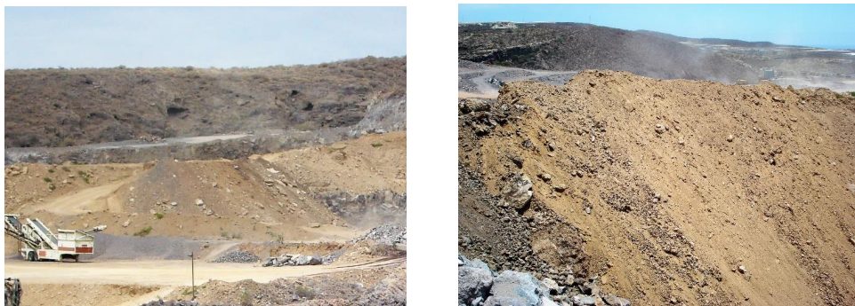
Figura 3.5.- Puzolana de cantera (izquierda) y acopios del desmonte en la cantera durante la extracción de la capa de basalto para la obtención de arena y grava (derecha).
