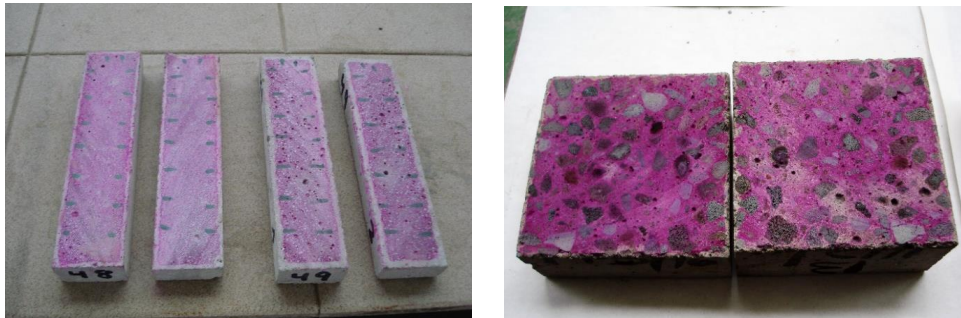
Figura 3.27.- Medida de la carbonatación de las muestras de mortero (izquierda) y de las muestras de hormigón (derecha).
