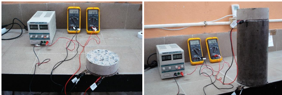
Figura 3.20.- Dispositivo experimental de medida del método directo o resistivímetro aplicado a las esponjas (izquierda) y a la probeta (derecha).
