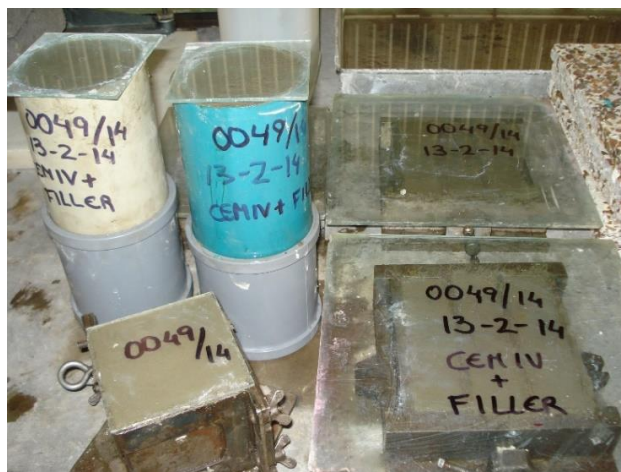
Figura 3.7.- Probetas de mortero en sus respectivos moldes.
