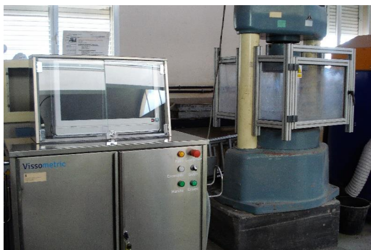
Figura 3.13.- Prensa de compresión de probeta de hormigón de 15x30.
