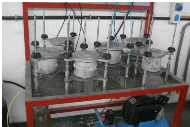
Figura 3.17.- Equipo de penetración de agua bajo presión.
