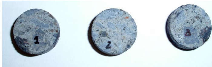
Figura 3.24.- Muestras de hormigón para el ensayo de porosidad por intrusión de mercurio.
