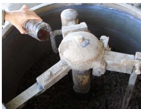
Figura All.4.- Introducción de los materiales en la hormigonera horizontal.
