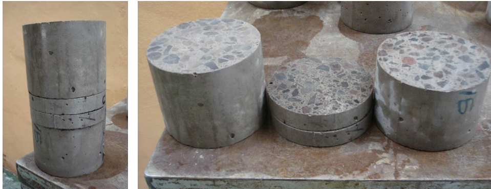
Figura 3.10.- Probeta cilíndrica cortada (izquierda) y despiece (derecha).
