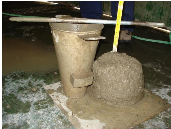
Figura 3.16.- Imagen de una muestra real ensayada mediante cono de Abrams.
