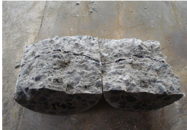
Figura 3.18.- Probeta después del ensayo agua bajo presión. En línea punteada negra se indica el frente de penetración.
