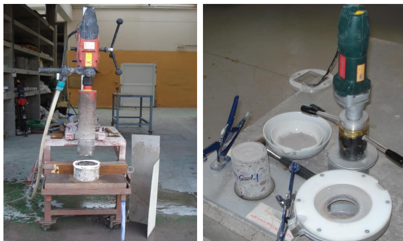
Figura 3.31.- Extracción del testigo a una probeta de hormigón (izquierda) equipo de fresado mm a mm para extraer muestras para su posterior análisis (derecha).
