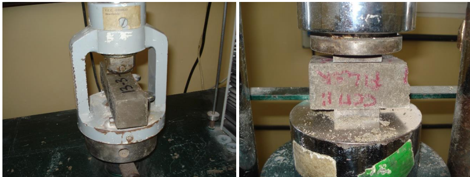
Figura 3.11.- Ensayo a flexión (izquierda) y ensayo a compresión (derecha) de morteros.
