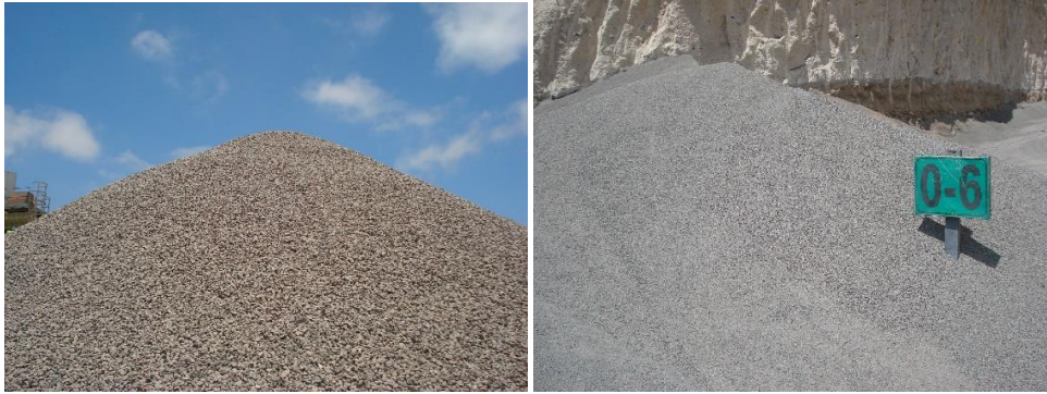
Figura 2.3.- Fotos de dos acopios de los áridos (grava 10/20 (izquierda) y arena 0/6 (derecha)).
