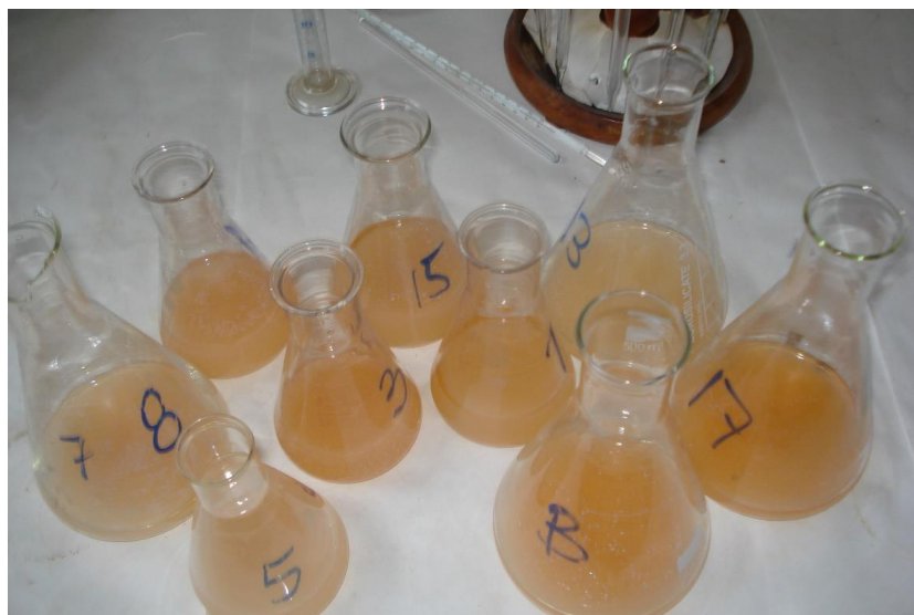
Figura 3.32.- Valoración del contenido de cloruros.
