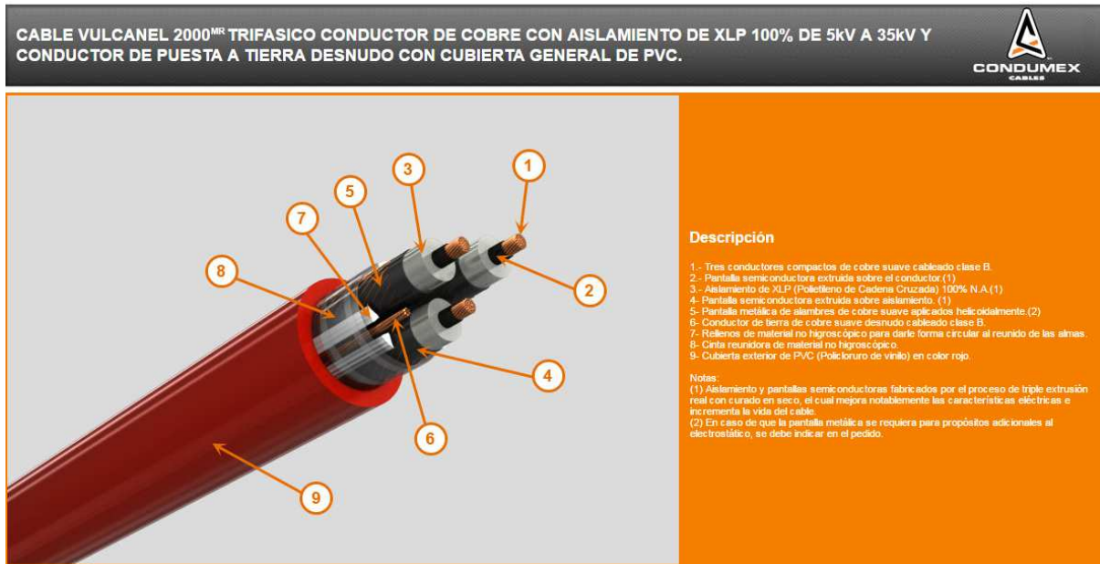
Ilustración 2.2. Cable Vulcanel 2000 trifásico para acometidas subterráneas.
