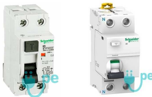
Ilustración 2.12. Diferenciales 2 x 40A, S = 300mA a la izquierda y S = 30mA a la derecha.
