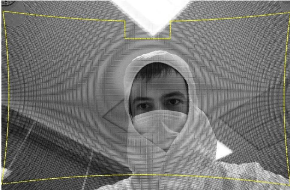
*Figura 3.8 Imagen plenóptica reproducida sin reducción de frecuencias espaciales, mostrando el efecto de "aliasing", y visualizando además el resultado de la corrección de la distorsión de campo.*
