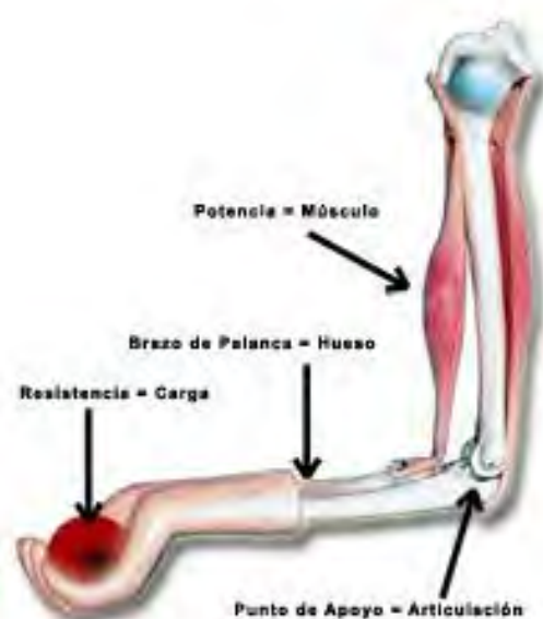
Fig. 11. Analogía biomecánica de un miembro con una palanca
