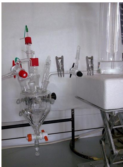
Figura 4.4. Celda electroquímica de flujo con el recipiente que contiene el electrolito.
