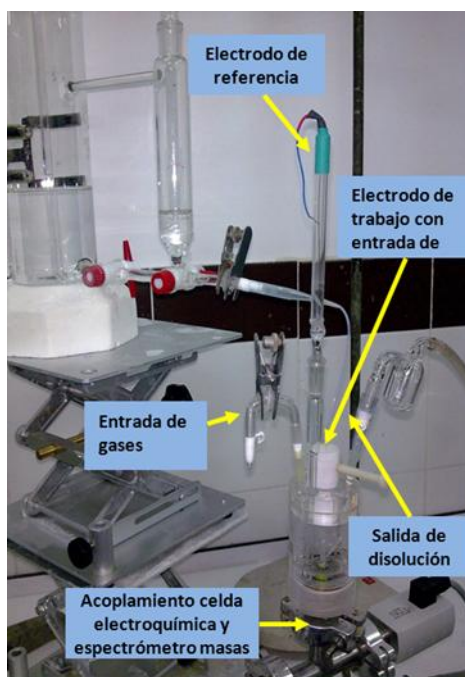
Figura 4.11. Montaje de la celda electroquímica de flujo en el DEMS.
