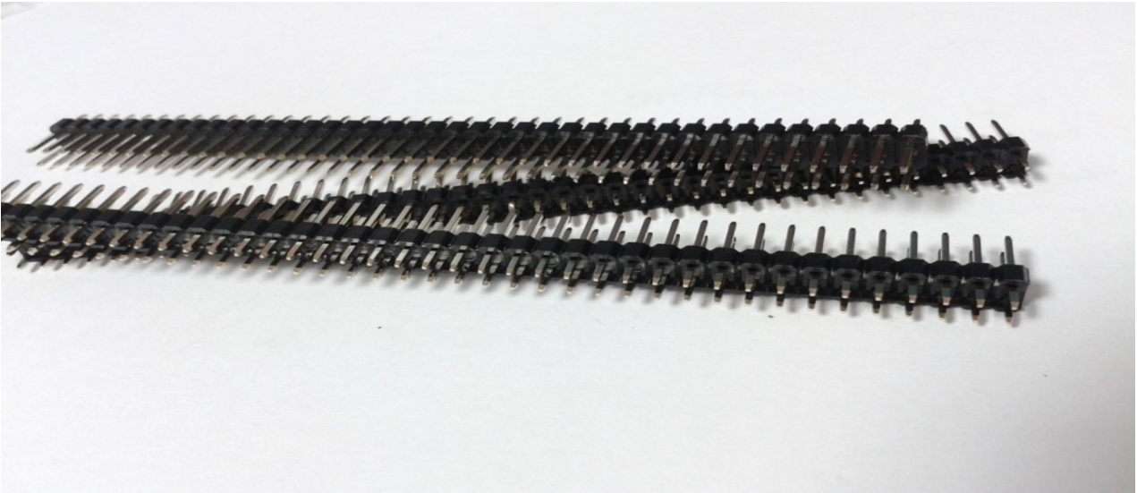
Ilustración 72: Conectores Monopines Headers
