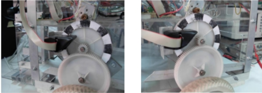
Disco de franjas para codificación del sensor CNY70.
