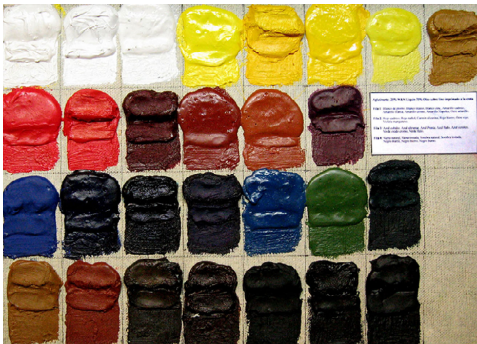
Fig. 16. Secado de los óleos alquídicos caseros sobre lino imprimado a la creta.
