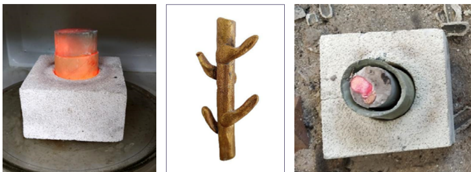
Fig. 8, 9 y 10 de izquierda a derecha. Muffla incandescente dentro del MW. Pieza «Forma B», reproducida en latón. Colada de metal por gravedad en el molde caliente dentro de la muffla abierta.
