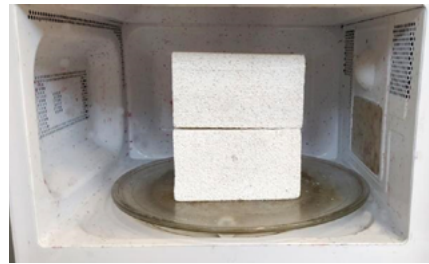
Fig. 5. Muffa cerrada en el interior del microondas.
