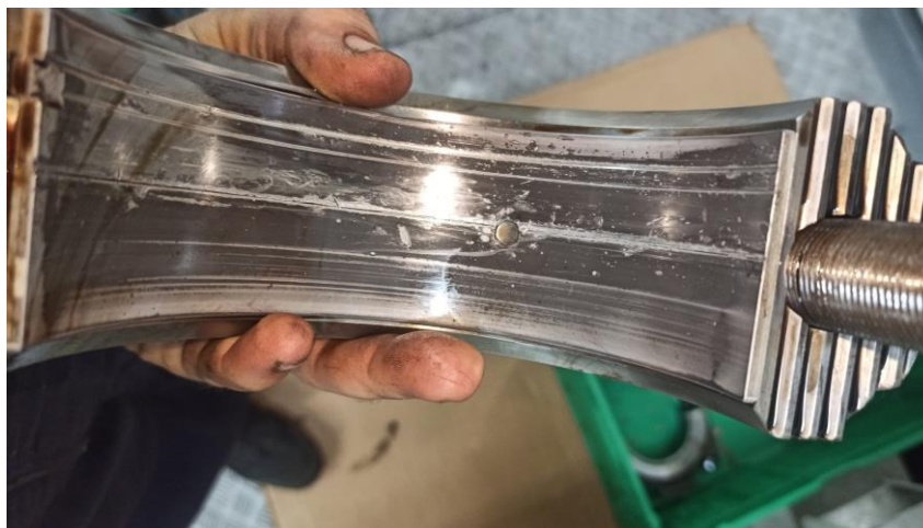
Ilustración 96. Cojinete de Biela Dañado. Fuente: Trabajo de Campo
