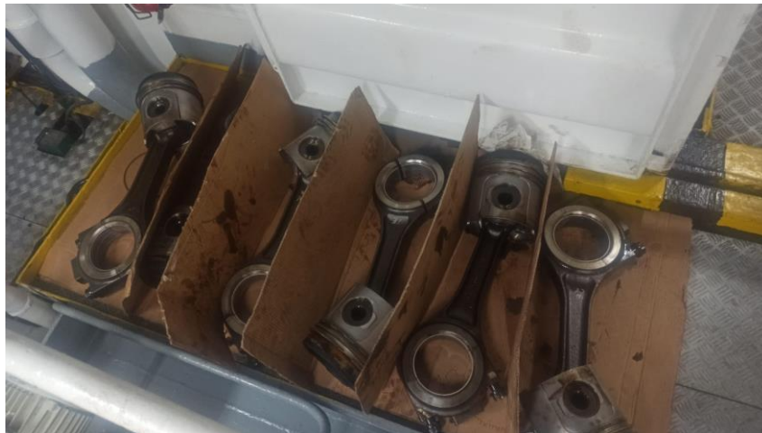
Ilustración 93. Desmontaje del Motor Auxiliar. Fuente: Trabajo de Campo
