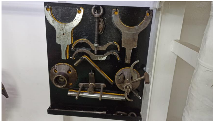
Ilustración 61. Útiles de la Depuradora. Trabajo de Campo
