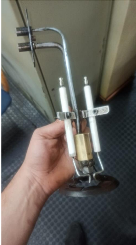
Ilustración 73. Quemador Limpio. Fuente: Trabajo de Campo
