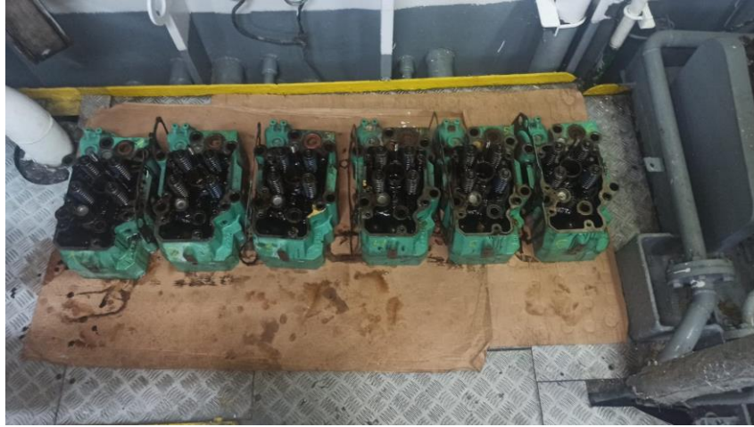
Ilustración 91. Desmontaje del Motor Auxiliar. Fuente: Trabajo de Campo
