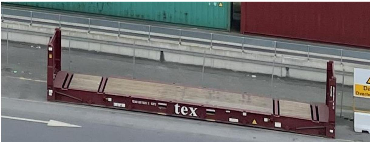
*Ilustración 7. Contenedor plataforma. Elaboración propia*
