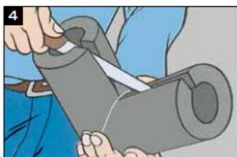
Fig 18 Corte en codo
