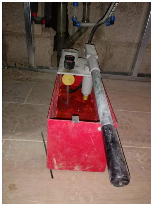
Fig 23 Ensayo de presión hidrostática.
