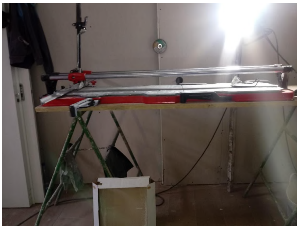
Fig 8 Cortadora Material Cerámico Fuente: propia
