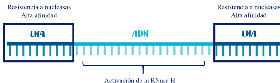
Figura 2. Estructura de un GapmeR formado por una porción de ADN flanqueada en ambos extremos por LNA. Las secuencias de LNA aumentan la afinidad por el objetivo y confieren resistencia a nucleasas, en cambio, la secuencia central de ADN se encarga de promover la activación de la RNasa H. Creado en BioRender
