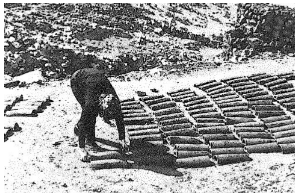
Colocando las tejas en el mantillo
