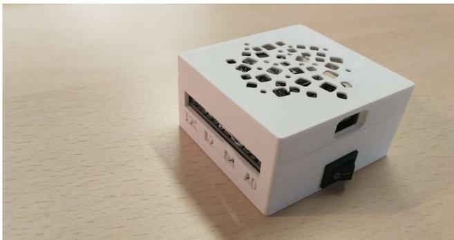
Figura 2: *SucreCore* impreso con tecnología 3D para los microcontroladores *Particle Argon*.
