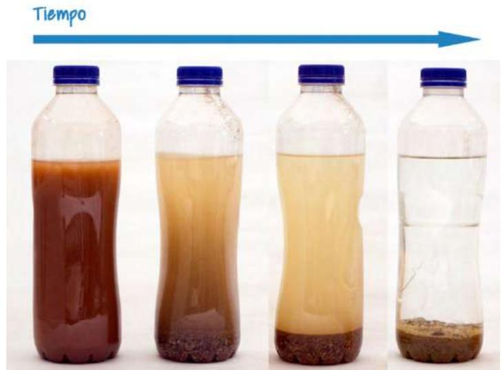
Figura 27. Tras agitar la muestra en la botella, las distintas partículas van sedimentando progresivamente.
