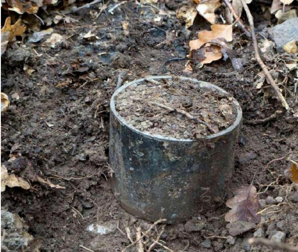
*Figura 22. Obtención de una muestra “inalterada” utilizando un cilindro metálico.*
