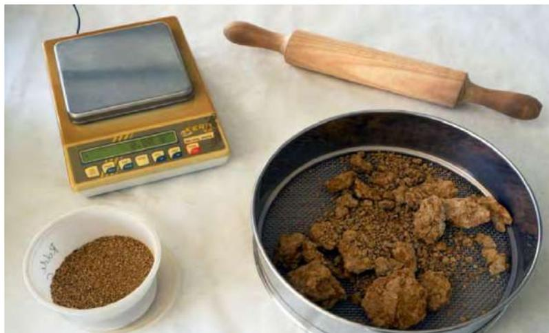
Figura 23. Material utilizado habitualmente para el cálculo de la proporción de elementos finos y gruesos de las muestras de suelo,
