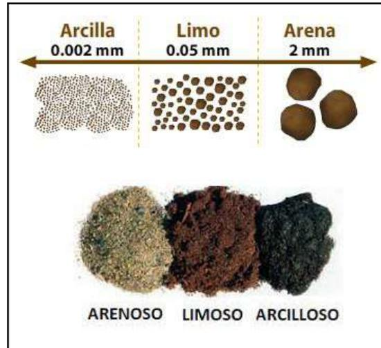
Figura 25. Partículas clasificadas según el tamaño de partícula: arena, limo y arcilla.
