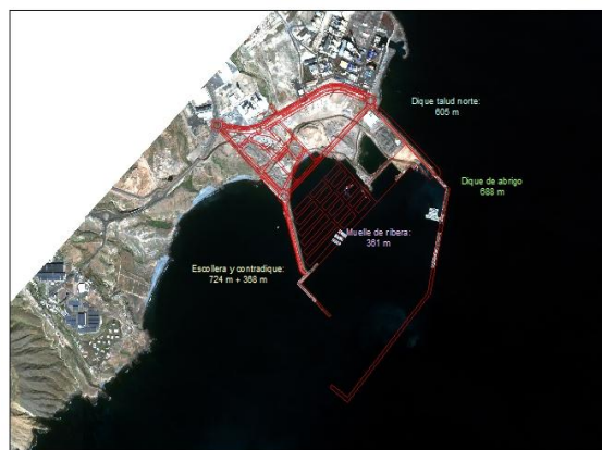
6. Fecha de toma: 14 de Diciembre de 2015. Se empieza a fondear los cajones en el Muelle de Ribera y tras terminar el dique de talud norte, comienzan los trabajos del contradique
