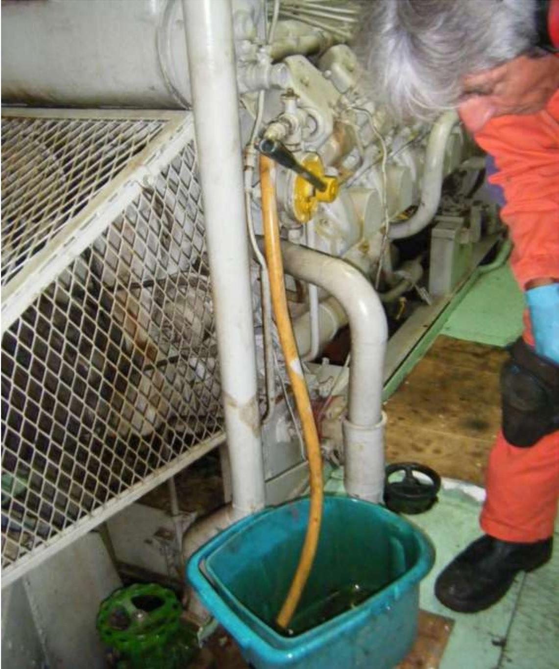
*Ilustración 39. Vaciado del cárter, motor auxiliar. Fuente: Elaboración propia.*
