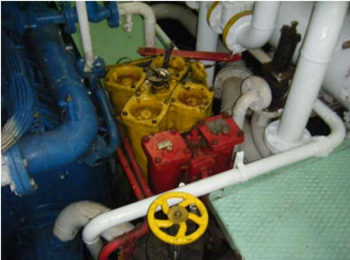
*Ilustración 12. Filtro mecánico de aceite lubricante (amarillo). Fuente: Elaboración propia.*
