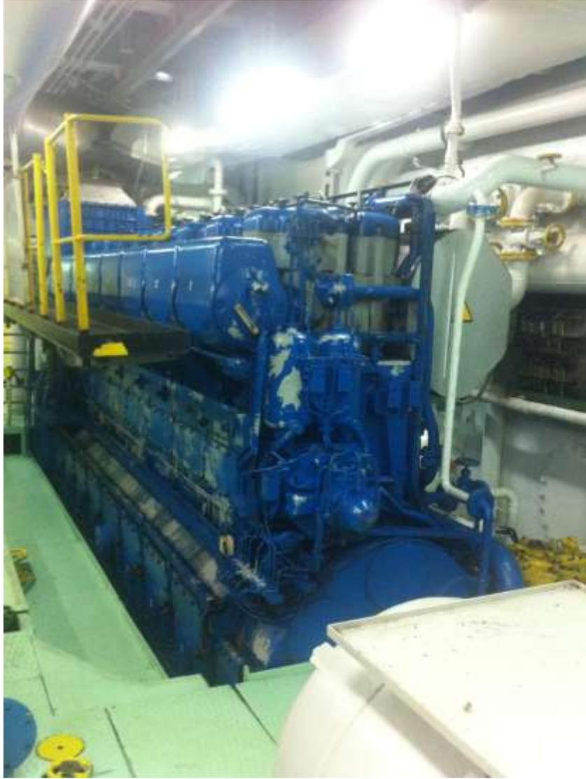
*Ilustración 3. Motor Principal DEUTZ, babor. Banda de estribor. Fuente: Elaboración propia.*
