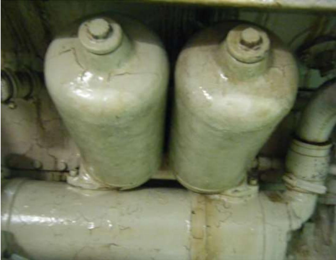
*Ilustración 33. Filtro de aceite y refrigerador de aceite. Fuente: Elaboración propia.*
