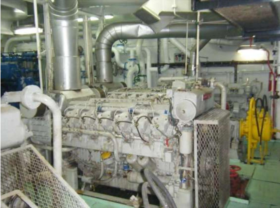
*Ilustración 31. Motor auxiliar BAUDIN GUASCOR DNP V. Fuente: Elaboración propia.*
