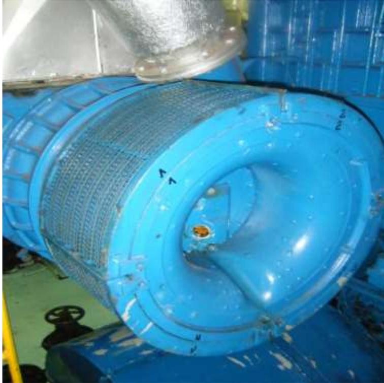
*Ilustración 18. Turbo motor principal estribor. Fuente: Elaboración propia.*
