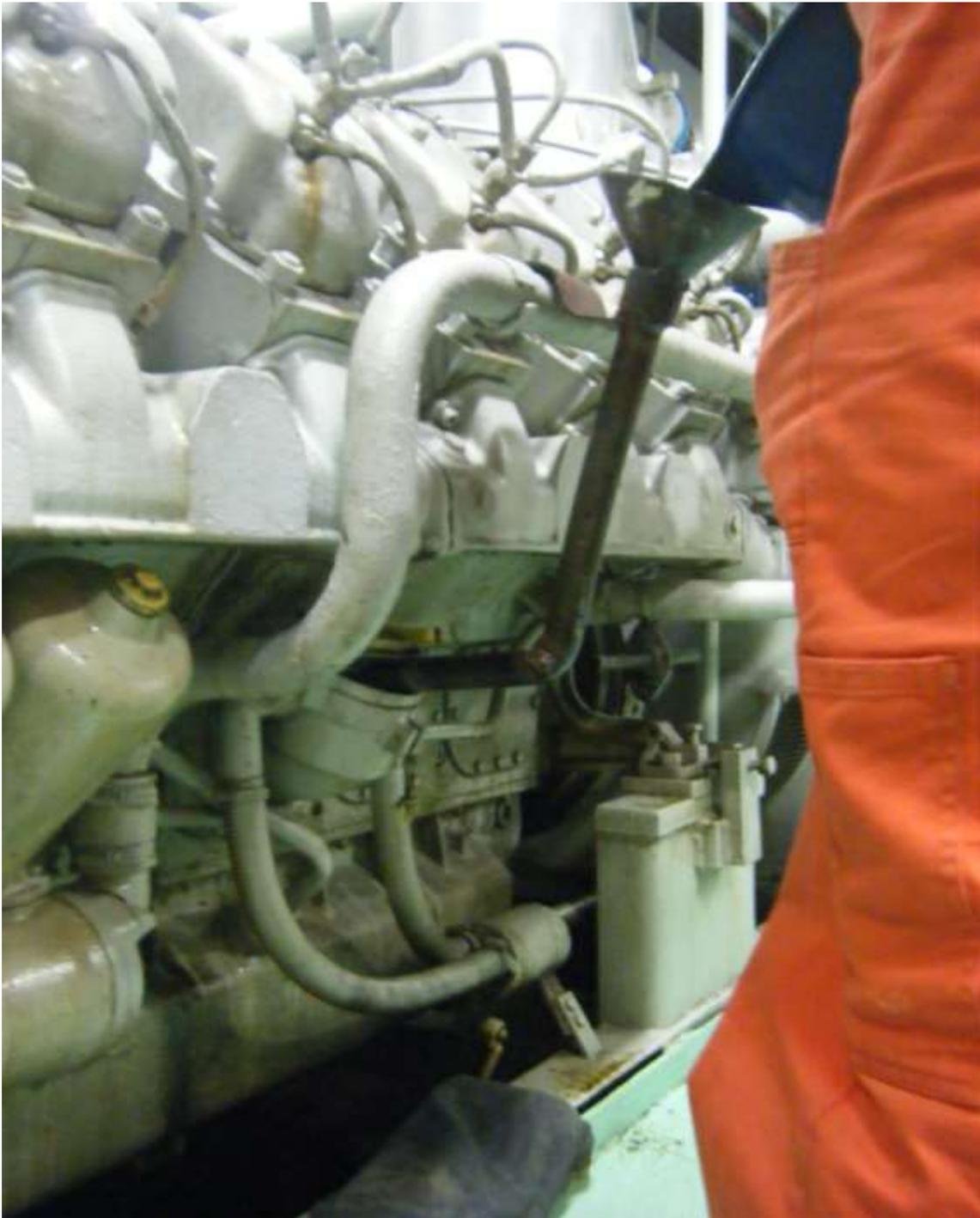
*Ilustración 38. Motor auxiliar "relleno del cárter". Fuente: Elaboración propia.*
