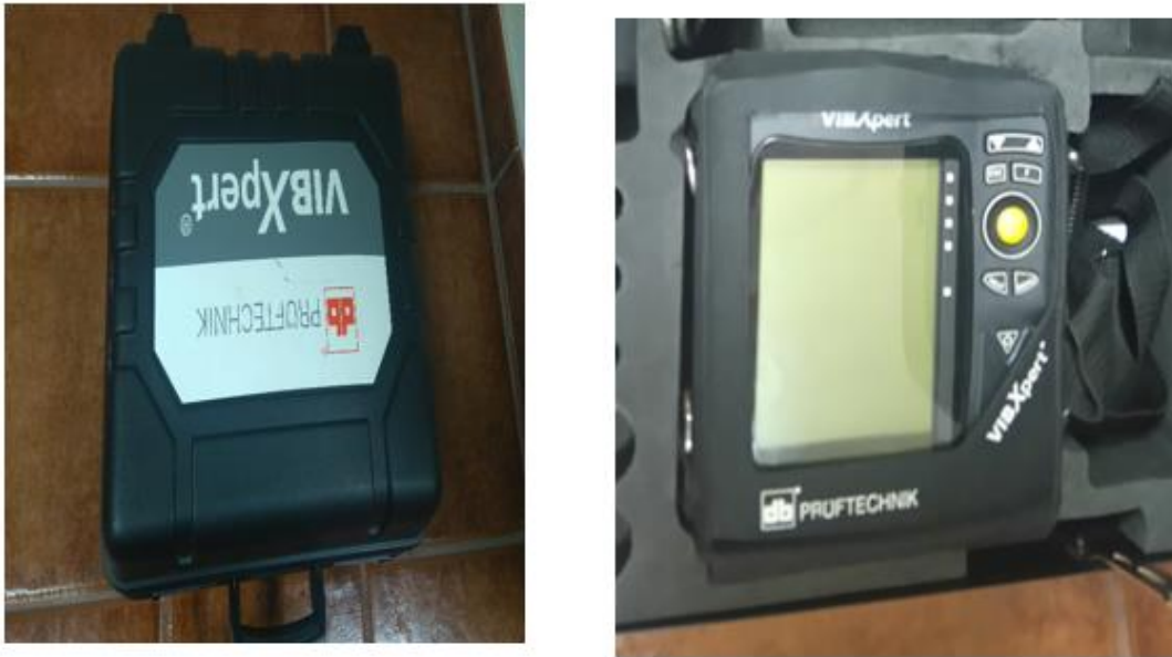
Ilustración 4: Analizador de vibraciones Prüftechnik
